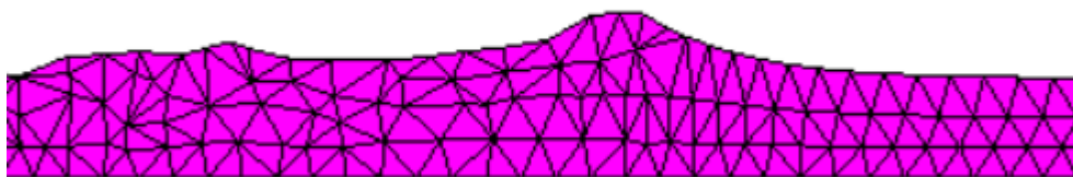
Figura 4.3.2.30 Propagación de la ola con tamaño de malla de 0.03-0.21m con t=7 seg
