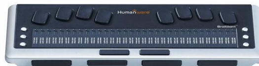
Figura 12. Dispositiu "Línea Braille" ( Acens Part of Telefónica Tech. (2012, July 26). Línea Braille: los invidentes ya pueden leer con sus manos en Internet. acens blog. Retrieved April 3, 2022, des de https://blog.acens.com/general/linea-braille-los-invidentes-ya-pueden-leer-con-sus-manos-en-internet/
