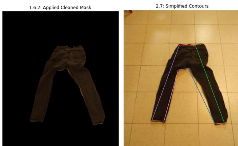
Fig. 9.4: Exemple de problemàtica en la parametrització de la peça. A l'esquerra màscara aplicada a la imatge original, aïllant la peça, a la dreta, contorns generats a partir de les cantonades.
