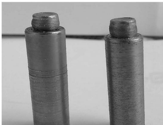
Figura 31: Deformació del punxó pel fort impacte durant el HSCM
