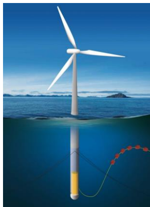
Figura 92. Plataforma eòlica flotant tipus SPAR (Windcrete) [50]
