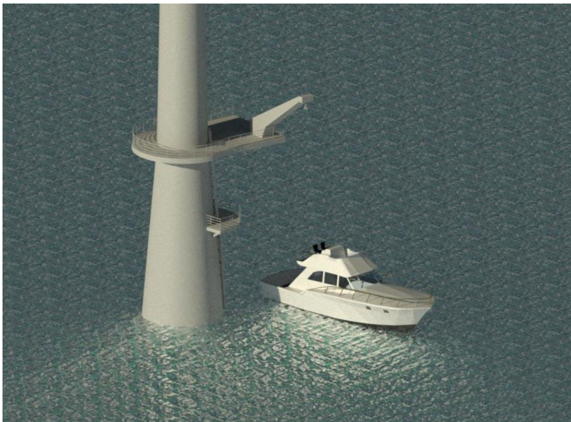
Figura 87. Renderitzacions de les estructures secundàries d'accés.
