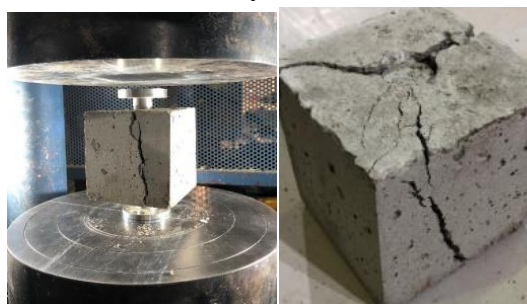
Figura 5.3. Ensayo BCN con probeta de hormigón MF 0,50. (Montero, 2021)
