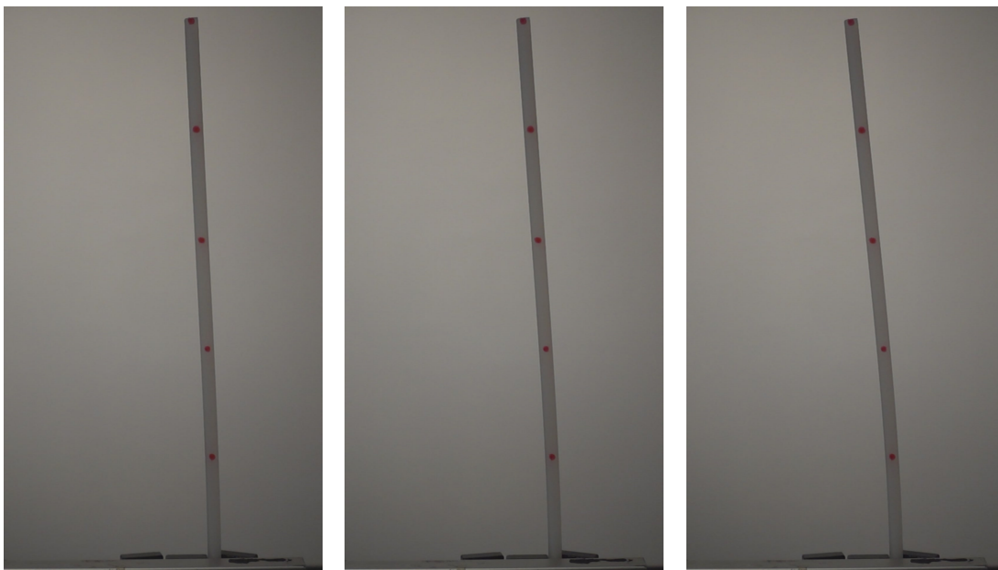
(d) Velocitat del flux d'aire: 15 m/s. (e) Velocitat del flux d'aire: 18 m/s. (f) Velocitat del flux d'aire: 21 m/s.
