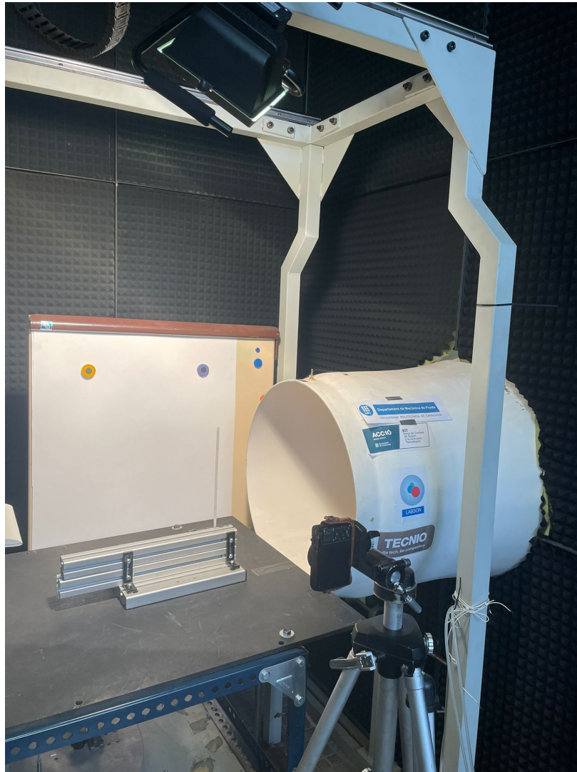
Figura 4.6: Sistema d'obtenció de dades experimentals mitjançant la gravació del moviment del cilindre sotmès a un flux d'aire, amb una càmera Sony RX100 IV.
