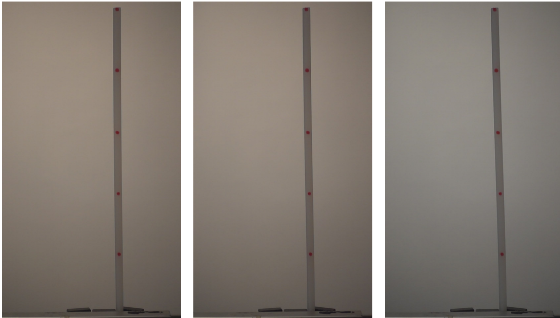
(a) Velocitat del flux d'aire: 6 m/s. (b) Velocitat del flux d'aire: 9 m/s. (c) Velocitat del flux d'aire: 12 m/s.
