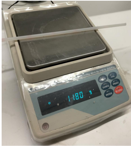
Figura 4.17: Massa del cilindre de niló Ertalon utilitzat en el procés d'experimentació al túnel de vent.
