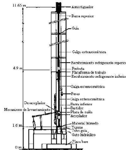
Ilustración 5.- Esquema del equipo Hopkinson utilizado en los ensayos. Vos y Reinhardt (1982).
