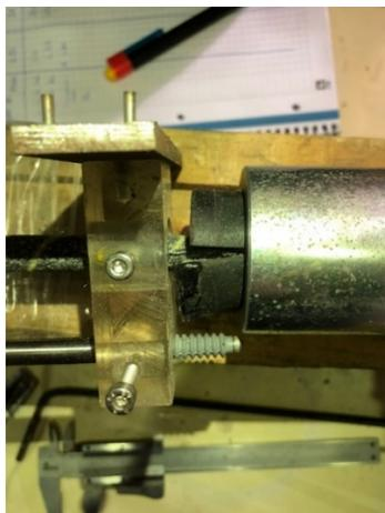
*Ilustración 125.- Fallo en 1er ensayo de anclaje en barra CFRP.
