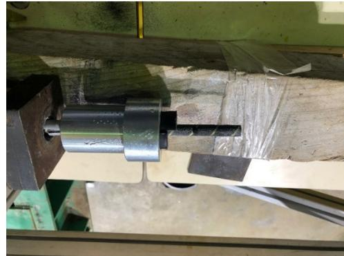
*Ilustración 117.- Penetración 3er ensayo lado pasivo para barra CFRP (aluminio). (Foto de fecha 15/02/2022)*
