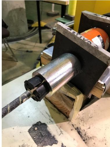
*Ilustración 59.- Sistema de cuñas para barra CFRP.
