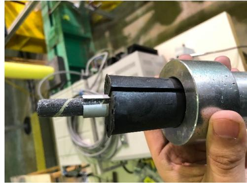
*Ilustración 111.- Abrazadera metálica de aluminio para barra CFRP. (Foto de fecha 15/02/2022)*
