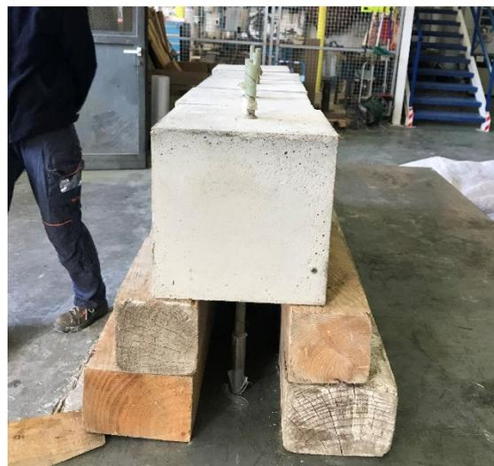
*Ilustración 41.- Preparación de probetas para prueba Pull out.
