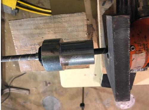
*Ilustración 118.- Penetración 3er ensayo lado activo para barra CFRP (aluminio). (Foto de fecha 15/02/2022)*
