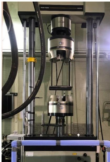
*Ilustración 83.- Equipo para pruebas de tracción marca "Instron 8803" UPC.
