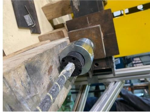
*Ilustración 119.- Penetración 4to ensayo lado pasivo para barra CFRP (aluminio y pegamento).
