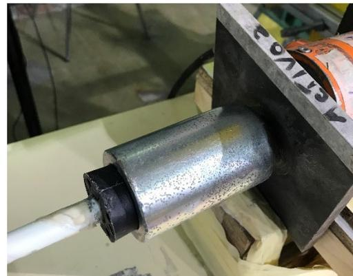
*Ilustración 61.- Sistema de Cuña para barra TGFRP.
