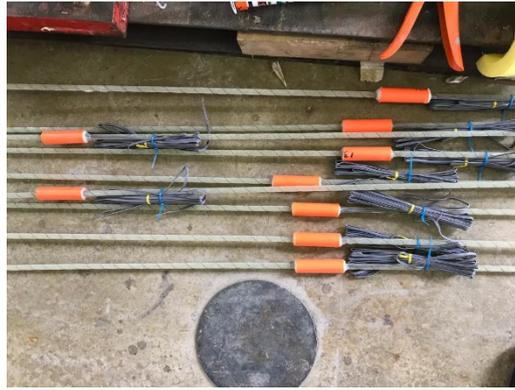
*Ilustración 79.- Protección de galgas en barras FRP con tubo PVC.
