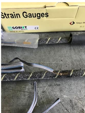
*Ilustración 87.- Galga 5-3-5 CFRP
