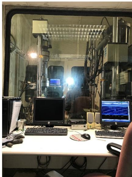
*Ilustración 46.- Procesamiento de datos y control de prueba Pull out.
