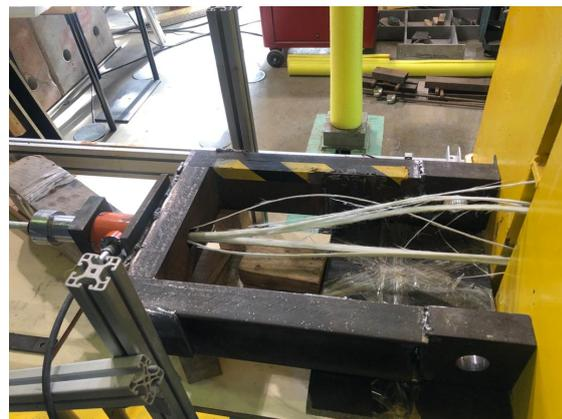
*Ilustración 106.- Prueba de anclaje con relajación hasta rotura de barra TGFRP. (Foto de fecha 11/02/2022)*
