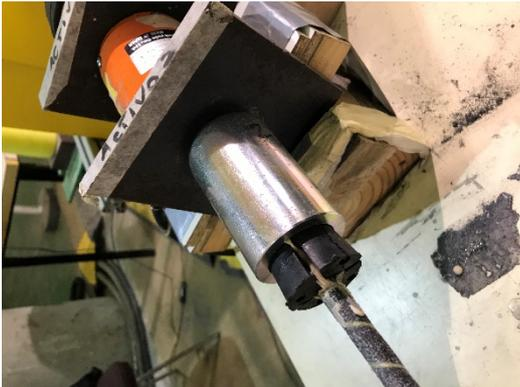
*Ilustración 123.- Anclaje de cuña en 4 piezas y pegamento X60 en lado activo, barra CFRP.
