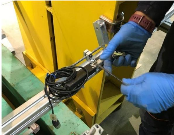
*Ilustración 84.- LVDT utilizado para medir deformación del bastidor UPC.
