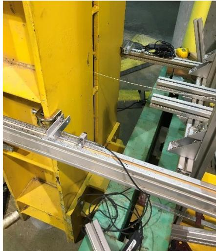
*Ilustración 52.- Colocación de 2 LVDT para monitoreo de bastidor UPC.
