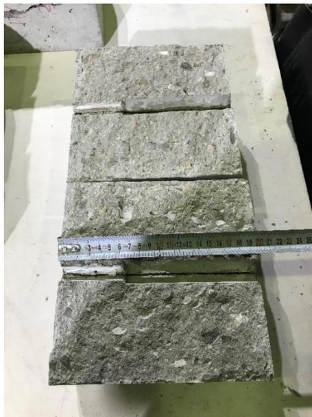
*Ilustración 44.- Probeta después de romper la probeta.
