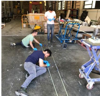
*Ilustración 78.- Pegado de galgas en barras GFRP para vigas de ensayo a flexión.
