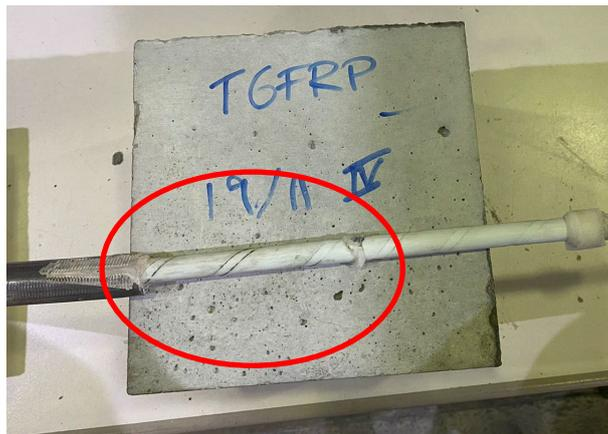
Ilustración 93.- Fallo de adherencia en barra TGFRP. (Foto propia fecha 24/11/2021).
