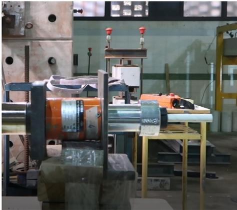
*Ilustración 101.- Anclaje en el lado activo de barra TGFRP. (Foto de fecha 03/02/2022)*
