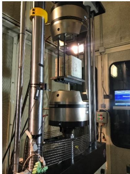
*Ilustración 42.- Muestra montada en equipo de tracción, barra GFRP.
