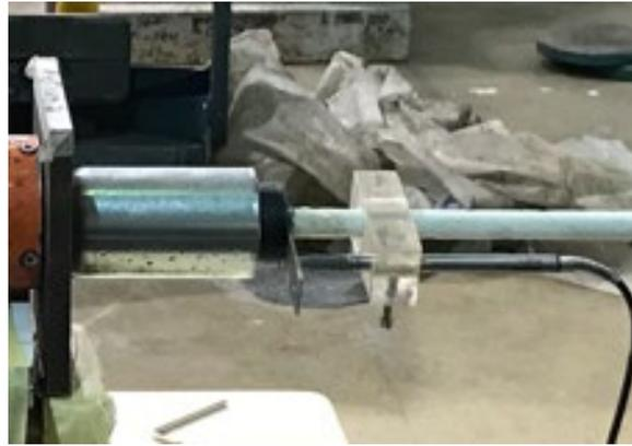
*Ilustración 62.- Colocación de placa y LVDT en barra TGFRP.
