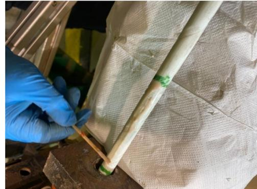
*Ilustración 103.- Surcos en barra TGFRP y pegamento X60. (Foto de fecha 11/02/2022)*
