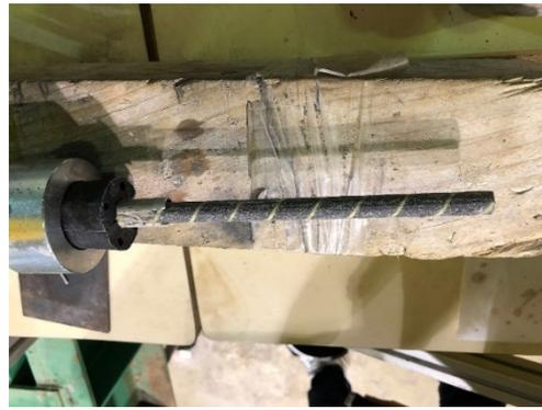
*Ilustración 122.- Fallo de la cuña en 4to ensayo en barra CFRP (aluminio y pegamento).
