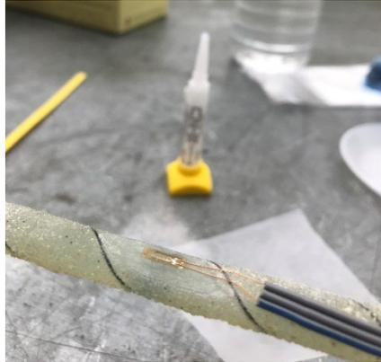
*Ilustración 31.- Pegado de galga en barra GFRP.
