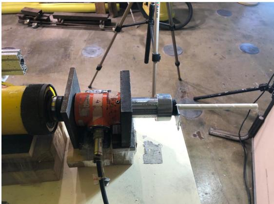
*Ilustración 105.- Tesado de Cuña plástica con surcos y pegada con X60 con relajación para barra TGFRP. (Foto de fecha 11/02/2022)*
