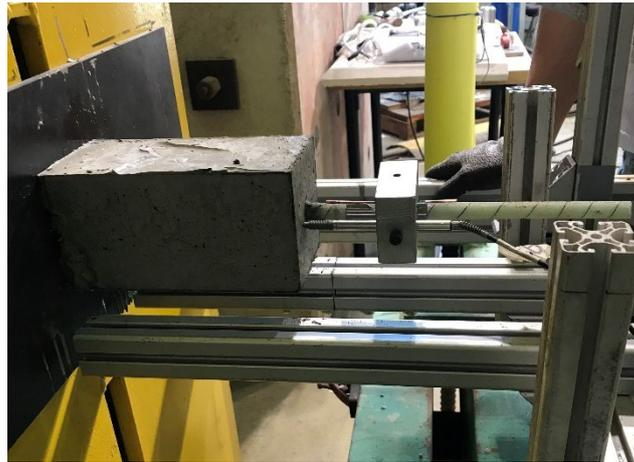
*Ilustración 70.- Instalación de LVDT probeta ECADA.
