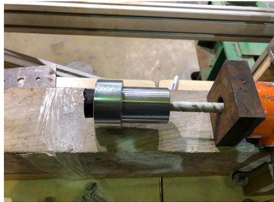
*Ilustración 100.- Anclaje en el lado pasivo de barra TGFRP. (Foto de fecha 03/02/2022)*
