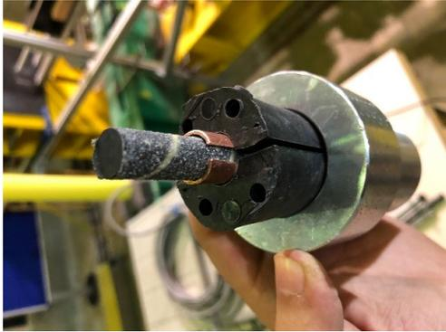
*Ilustración 112.- Abrazadera metálica de cobre para barra CFRP. (Foto de fecha 14/02/2022)*
