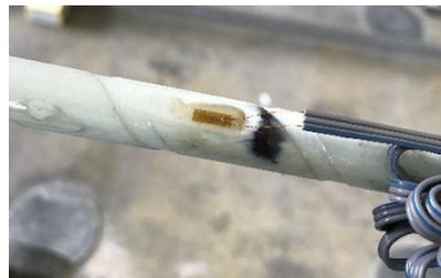
*Ilustración 32.- Protección de galga NP-50B en barra TGFRP.
