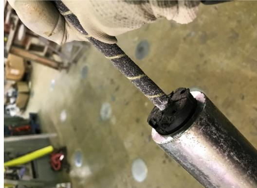
*Ilustración 124.- Anclaje de cuña en 4 piezas y pegamento X60 en lado pasivo, barra CFRP.
