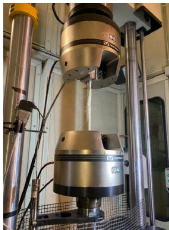
*Ilustración 35.- Muestra montada en equipo de tracción, barra GFRP.
