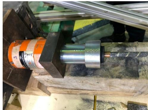
*Ilustración 116.- Penetración 2do ensayo lado pasivo para barra CFRP (cobre). (Foto de fecha 14/02/2022)*
