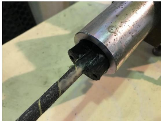
*Ilustración 127.- Fallo de anclaje final de la 3ª campaña de barra CFRP.
