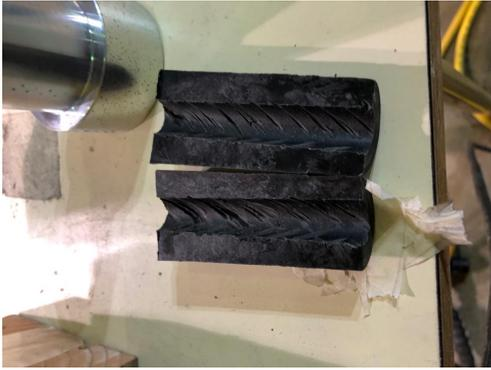
*Ilustración 104.- Cuña plástica con surcos y pegada con X60 para barra TGFRP. (Foto de fecha 11/02/2022)*
