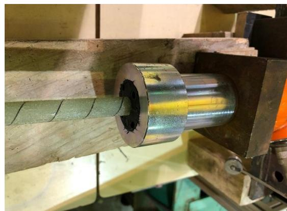
Ilustración 98.- Anclaje al fallo en el lado pasivo de barra GFRP. (Foto de fecha 20/01/2022)
