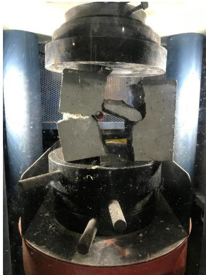
*Ilustración 43.- Partido de la probeta cubica.
