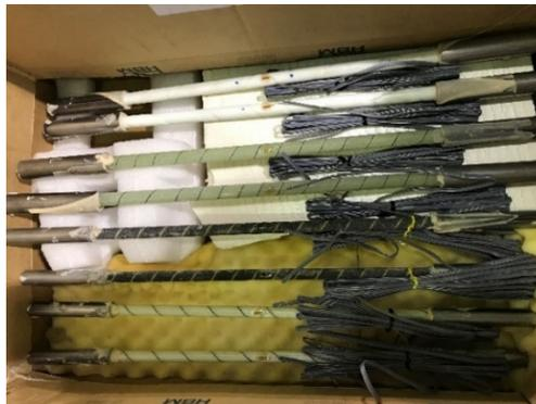
*Ilustración 33.- Colocación de galgas Extensiométricas en barras FRP.
