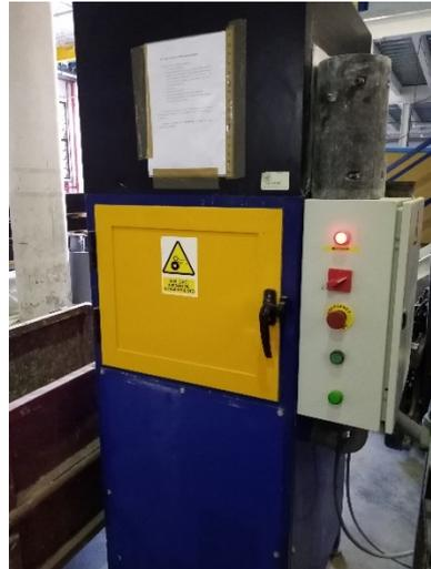
**Ilustración 73.- Equipo de pulido de cilindros de prueba UPC.**
