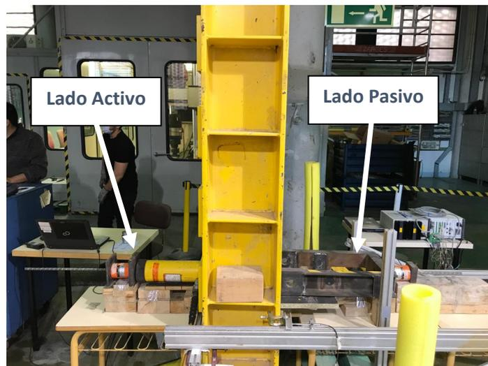
Ilustración 95.- Sistema de ensayo para verificación de anclaje de barras FRP.
