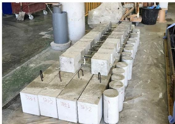
*Ilustración 39.- Probetas hormigonadas y cilindros de prueba Pull out desencofrados a las 24 hrs.
