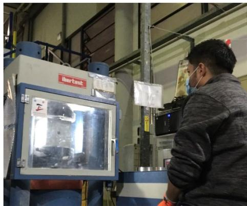
**Ilustración 74.- Equipo de prueba compresión test MEH-3000 UPC.**
