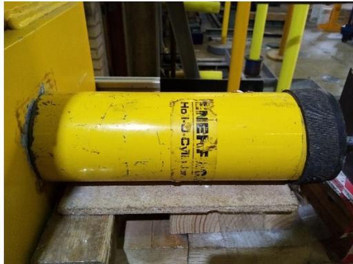
*Ilustración 86.- Gato hidráulico utilizado en las pruebas ECADA test, UPC.
