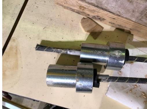
*Ilustración 126.- Fallos de anclajes final de la 2ª campaña en los dos lados de barra CFRP.
