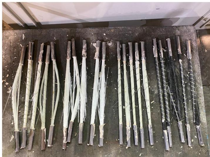
*Ilustración 92.- Barras FRP después de los Ensayos Test and test. (Foto propia fecha 29/11/2021).*
