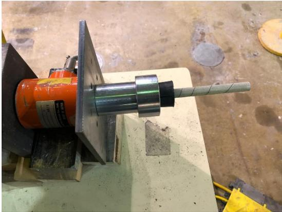
Ilustración 97.- Anclaje en el lado activo de barra GFRP.
