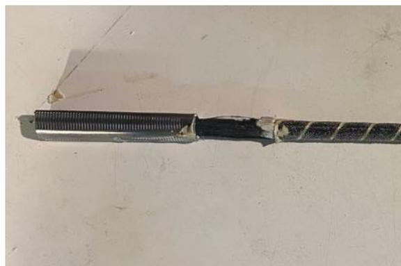
Ilustración 90.- Fallo de anclaje de barra CFRP. (Foto tomada por Kathrina Vangen 29/11/2021).
