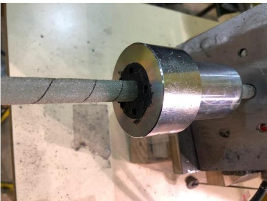
Ilustración 99.- Anclaje al fallo en el lado activo de barra GFRP. (Foto de fecha 20/01/2022)
