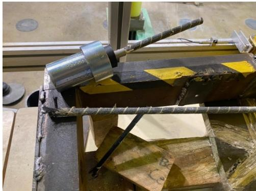
*Ilustración 121.- Fallo en 4to ensayo lado activo para barra CFRP (aluminio y pegamento).
