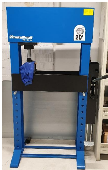
Figura 6.3. Prensa utilizada durante el proceso de prensado del hidrogel [Fuente propia].
