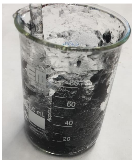
Figura 6.5. Hidrogel con PEDOT previo a ser prensado [Fuente propia].
