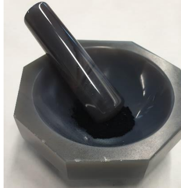
Figura 6.6. Muestra de PEDOT pulverizada en el mortero [Fuente propia].
