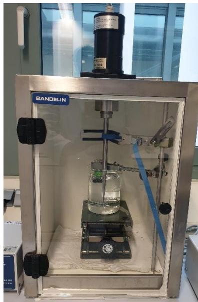
Figura 6.7. Muestra de PEDOT en la sonicadora [Fuente propia].
