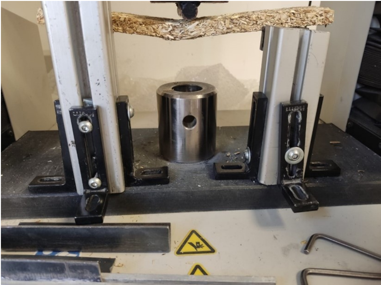
Figura 3.23: assaig de flexio fet
