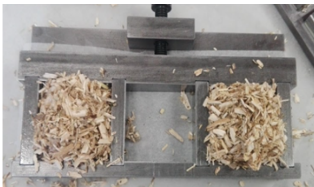
Figura 3.21: compressió manual en el motlle petit
