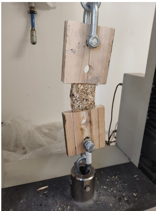
Figura 3.31: Assaig de tracció fet
