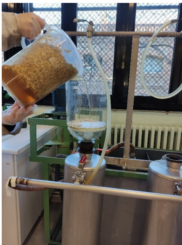
Figura 3.14: colocacio canemuixa bomba de buit
