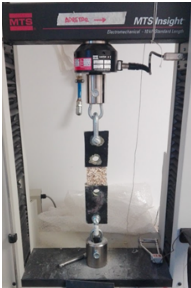
Figura 3.30: Assaig de tracció
