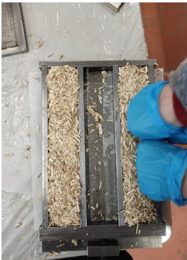
Figura 3.20: compressió manual en el motlle gran
