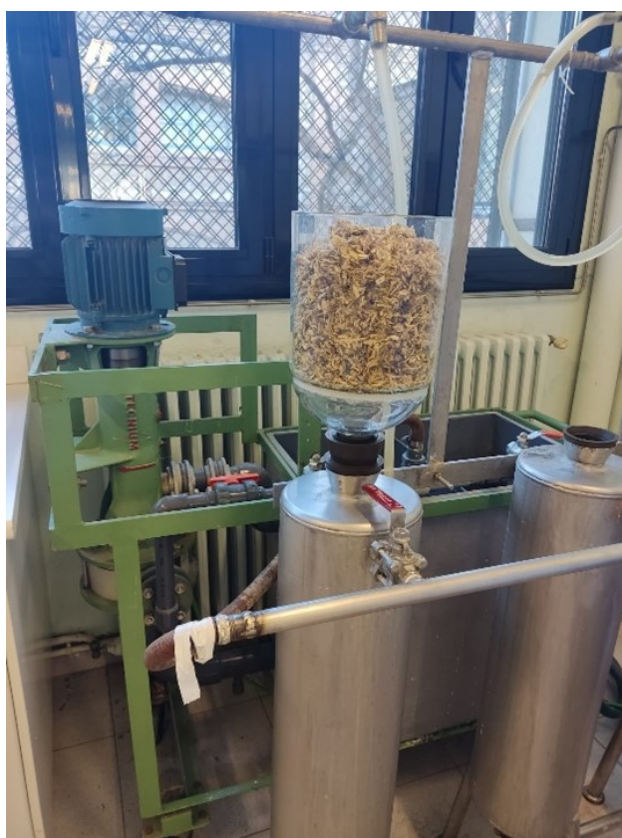
Figura 3.15: extraccio aigua de la canemuixa
