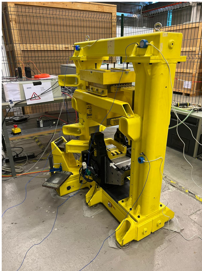
Figura 45 Set-up dels acceleròmetres sobre l'estructura sota estudi
