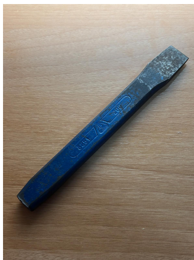
Figura 20 Cisell utilitzat per generar vibracions en la biga
