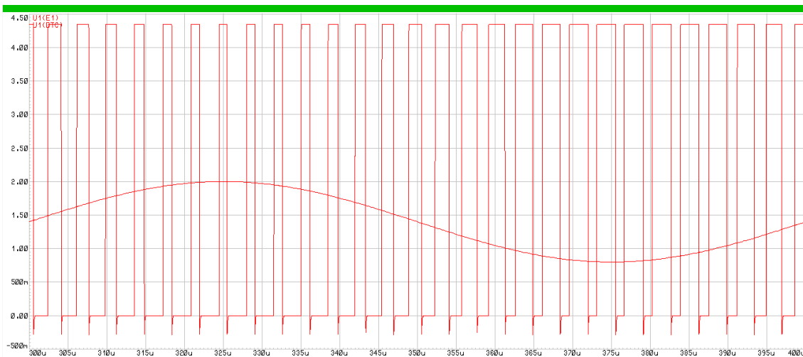
Fig. 48: Señal de entrada DTC y señal PWM modulada
