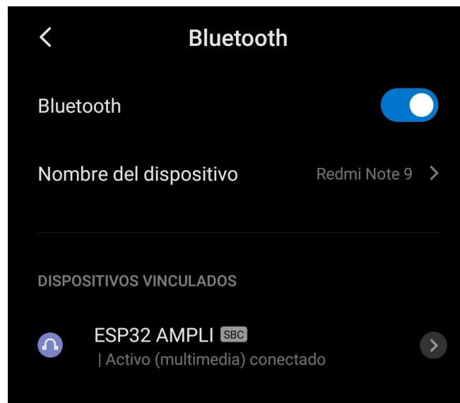
Fig. 80: Conexión Bluetooth establecida con códec SBC
