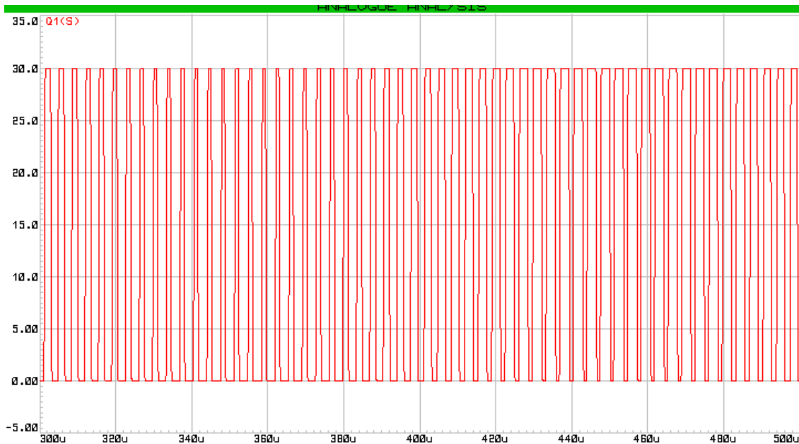
Fig. 66: Señal de salida modulada 300kHz Vpower=30V
