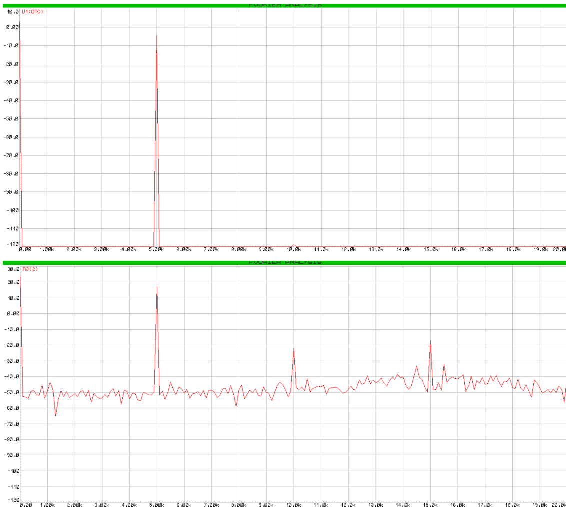
Fig. 75: Espectro audible, señal de entrada (superior) y de salida (inferior)
