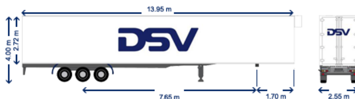
Il·lustració 32.- Dimensions contenidor de trailer
