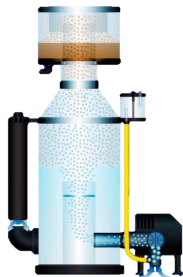
Esquema 6 Funcionamiento de un protein skimmer
