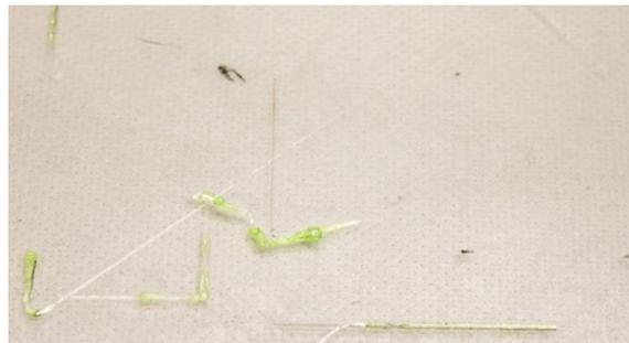
*Ilustración 44. Escasez de filamento en la extrusión. (Leon3D, 2022)*
