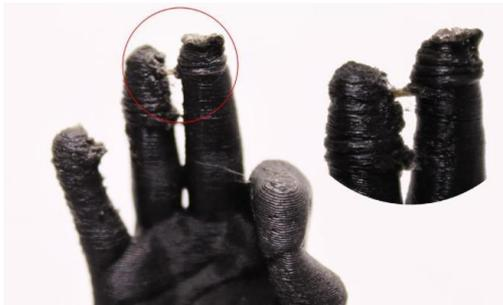
*Ilustración 48. Deformación de impresión por sobrecalentamiento. (Leon3D, 2022)*
