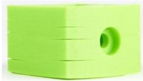
*Ilustración 55. Cracking. (3Dmarket, 2022)*
