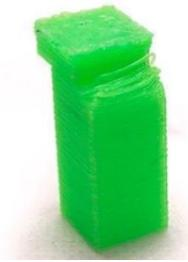
*Ilustración 50. Desplazamiento de capas durante la extrusión. (Leon3D, 2022)*
