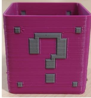
*Ilustración 74. Aplicación de la doble extrusión.*
