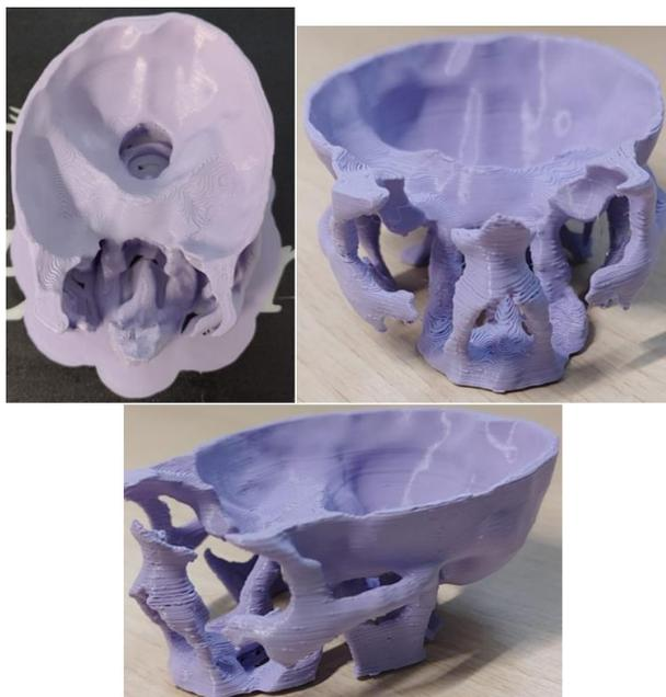
Ilustración 70. Tercer intento, con una menor altura de capa, menor velocidad de impresión, menor escala y habilitando la retroacción.
