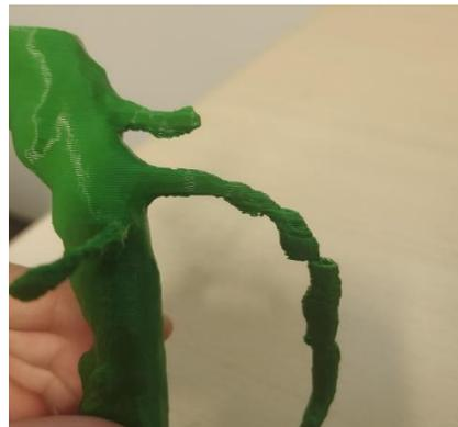
*Ilustración 63. Desplazamiento de capas durante la impresión.*
