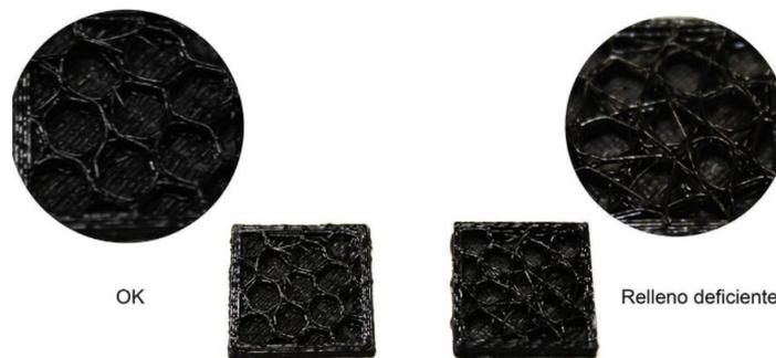
*Ilustración 51. Patrón de relleno impreso correctamente (izquierda) y patrón de relleno deficiente (derecha). (Leon3D, 2022)*
