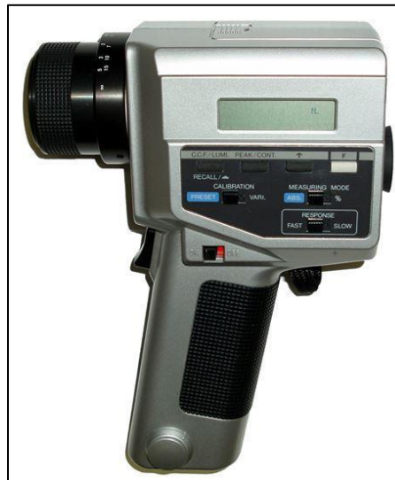
Figura 8: Luminancímetre utilitzat per al calibratge fotomètric.
