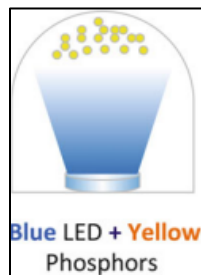
Figura 23: Esquematzació de l'obtenció de llum blanca pc-LED (Font: Al-Amri, M. D., El-Gomati, M. M., & Zubairy, M. S. (2016). Optics in our time. In Optics in Our Time (pp. 1–504))
