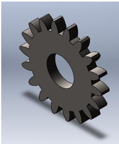
Il·lustració 52 Pinyó per cadena. Font: Elaboració pròpia
