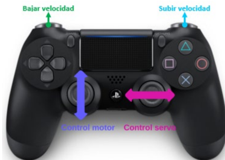
Figura 6.21. Esquema de actuación de los joysticks izquierdo y derecho, y de los botones L1 y R1 (Fuente: propia).
