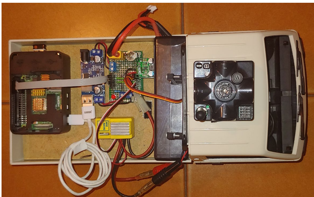
Figura 6.4. Resultado final del montaje del vehículo (Fuente: propia).
