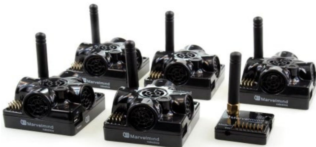
Figura 4.4. Sistema de navegación: balizas y módem. Esquina inferior derecha se encuentra el módem y el resto son las balizas (Fuente: [8]).
