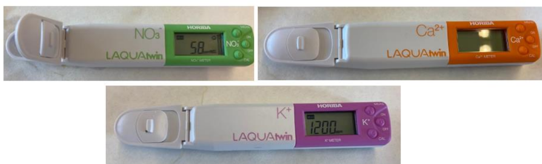
Figura 3-27. Sensors Laquatwin de mesura de nitrats, calci i potassi
