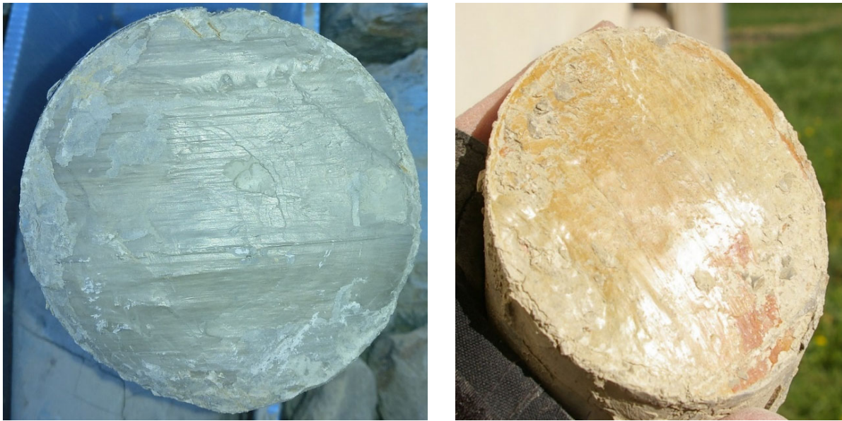
Figura 4. Planos arcillosos finamente estriados y pulidos en los testigos de sondeos. Izquierda: sondeo SCI-41, a profundidad de 26,7 m. Derecha: sondeo SCI-26, a profundidad de 49,5 m.
