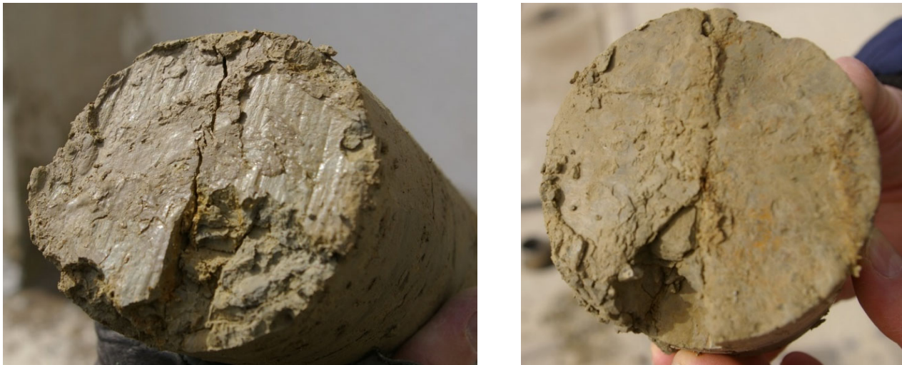
Figura 7. Planos arcillosos estriados no aptos para su ensayo a corte directo. Izquierda: sondeo SCI-41, a profundidad de 37,0 m. Derecha: sondeo SCI-41: a profundidad de 29,4 m.
