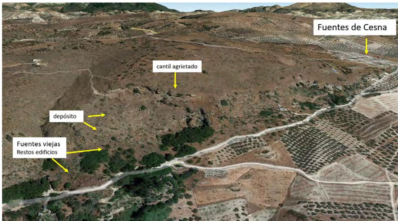
Figura 5. Vista del cantil de la Sierra del Alcornocal, con las grietas todavía visibles en el cantil donde se desprendió la masa rocosa que destruyó el antiguo emplazamiento de Fuentes de Cesna (Fuentes Viejas). Imagen GoogleEarth ®.
