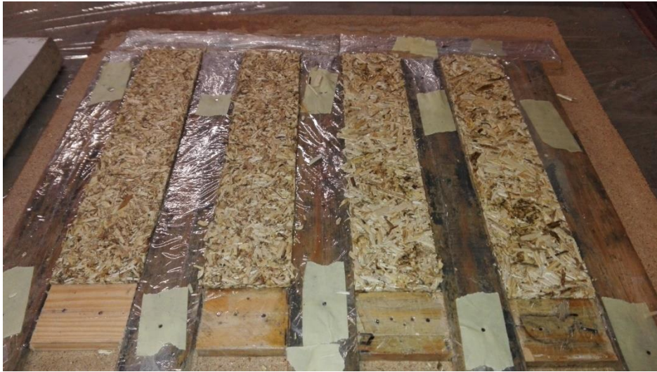
Figura 25. Provetes assecades al motlle de fusta
