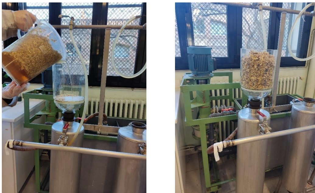
Figura 17. Extracció de l'excés d'aigua en la bomba de buit
