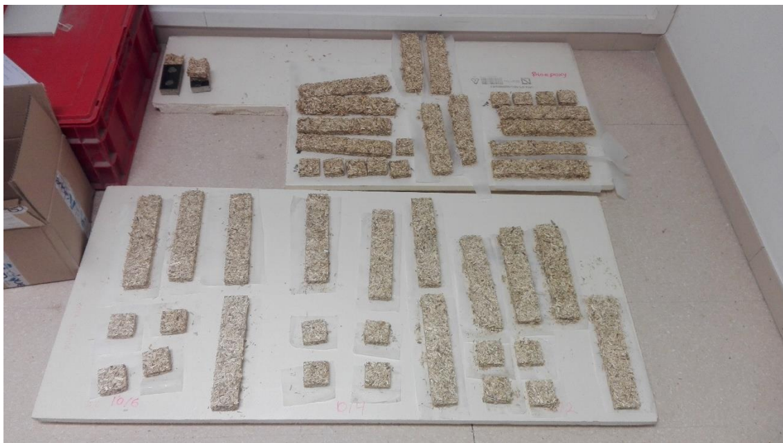
Figura 27. Algunes de les provetes de Cola Blanca i resina Epoxy
