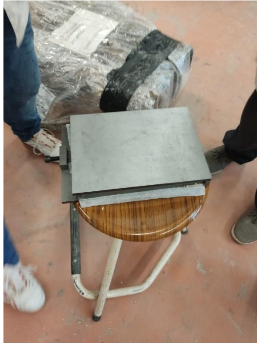
Figura 22. Motlle preparat per a la compactació
