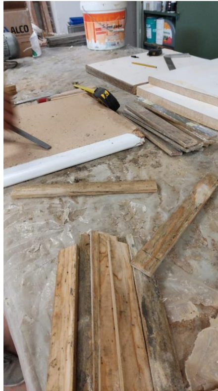
Figura 12. Fabricació motlles de fusta
