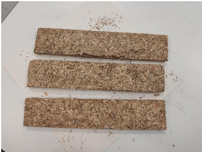
Figura 26. Provetes assecades al forn
