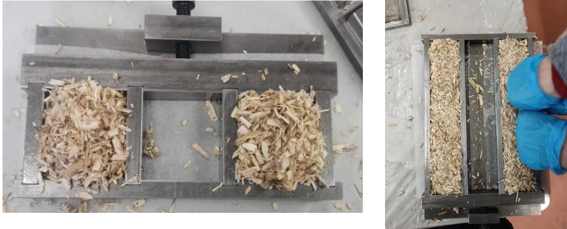
Figura 21. Col·locació i compactació manual de la mescla en els dos motlles
