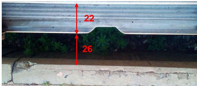
Figura 29. Mides del comboi escollit de la sèrie 450/451 de l'interior i de l'ample –les dues superiors–, l'alçada i la profunditat –les dues inferiors– d'accés.
