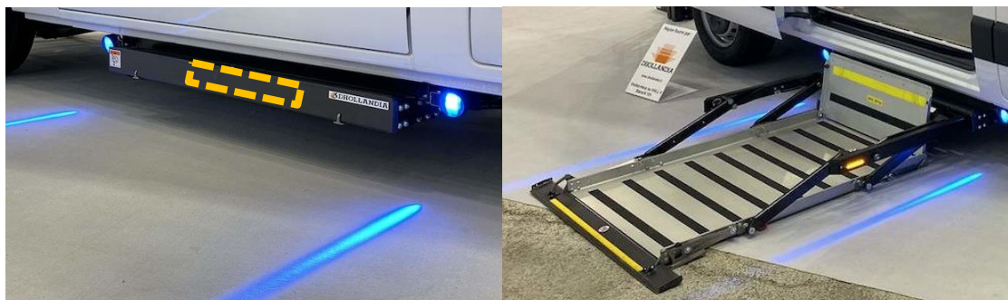
Figura 43. Posició i aspecte dels llums de la plataforma elevadora [65].
