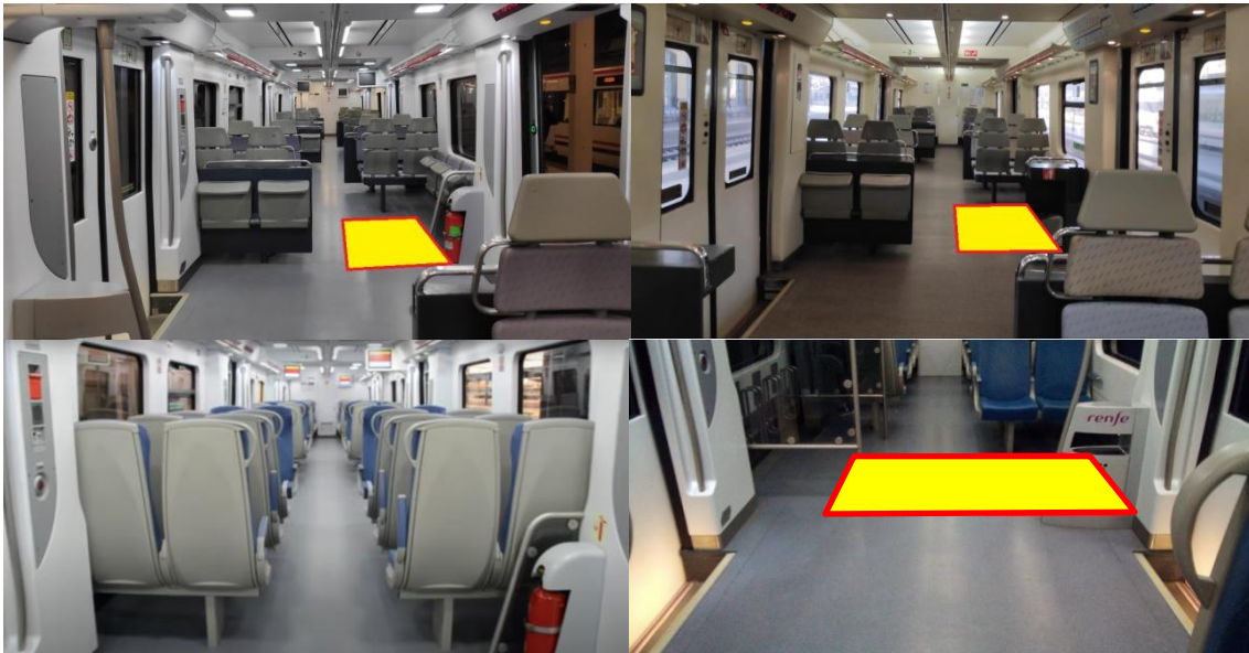
Figura 15. Espai d'aparcament del 447 sense vago PMR [28] [29] [30] 17 .
