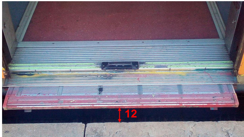
Figura 32. Mides en cm del comboi PMR de la sèrie 465 de l'ample, alçada –superior– i profunditat –inferior– d'accés.
