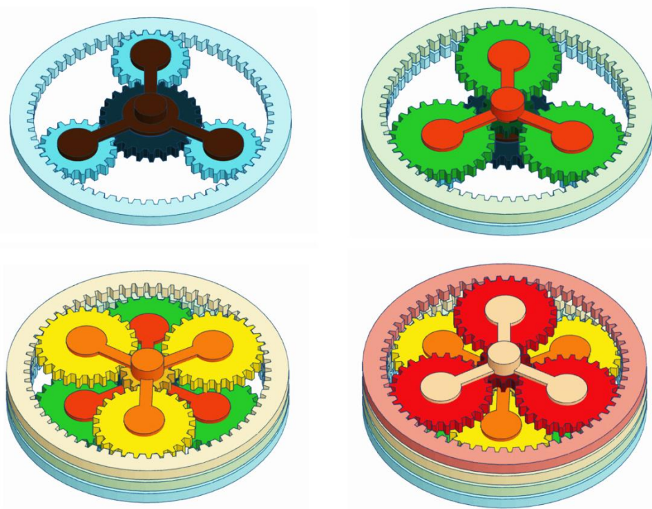
Figura 53. Vista ortogonal de les diferents etapes reductores.
