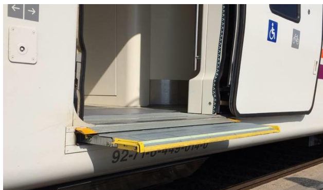
Figura 22. Accés PMR de la sèrie 449 que no s'ajusta a l'andana [35].
