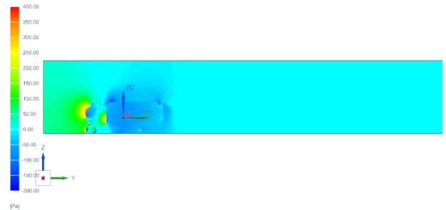
Fig.16. Presión estática camión cisterna vista lateral
