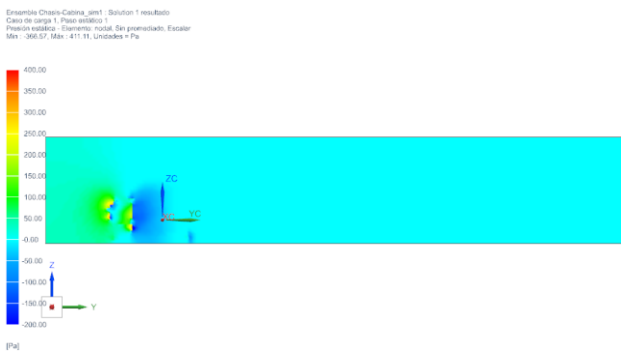
Fig.12. Presión estática camión chasis cabina vista lateral
