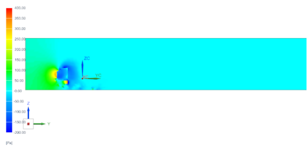
Fig.14. Presión estática camión caja abierta vista lateral
