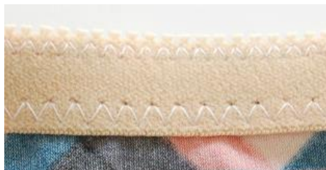
Figura 20. Fotografía de unión tipo zigzag de una cinta elástica [38].
