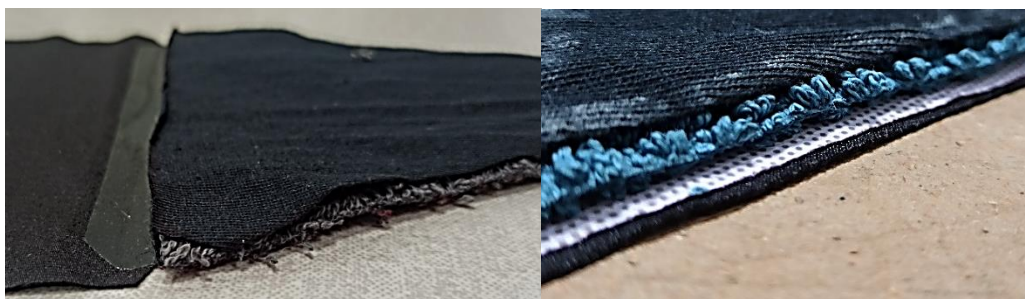
Figura 40. Comparativa entre “Pad” con Acabado sobre Tejido contra “Pad” con PUL.
