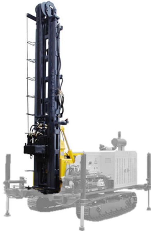
Figura 2: Máquina perforadora para pozos de agua KW30 (Font: Kaishan drillings) [18]
