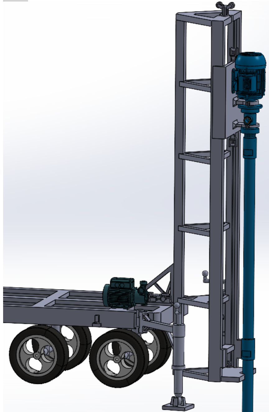
Figura 9: Nova canonada a la perforadora (Font pròpia)
