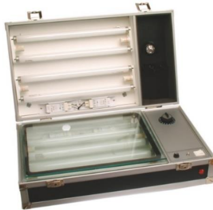
Figura 54. Insoladora UV empleada para la fabricación de las PCB. Fuente:[31]
