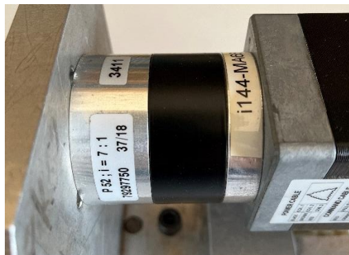
Figura 29. Transmisión reductora de engranajes planetarios. Fuente [Propia]
