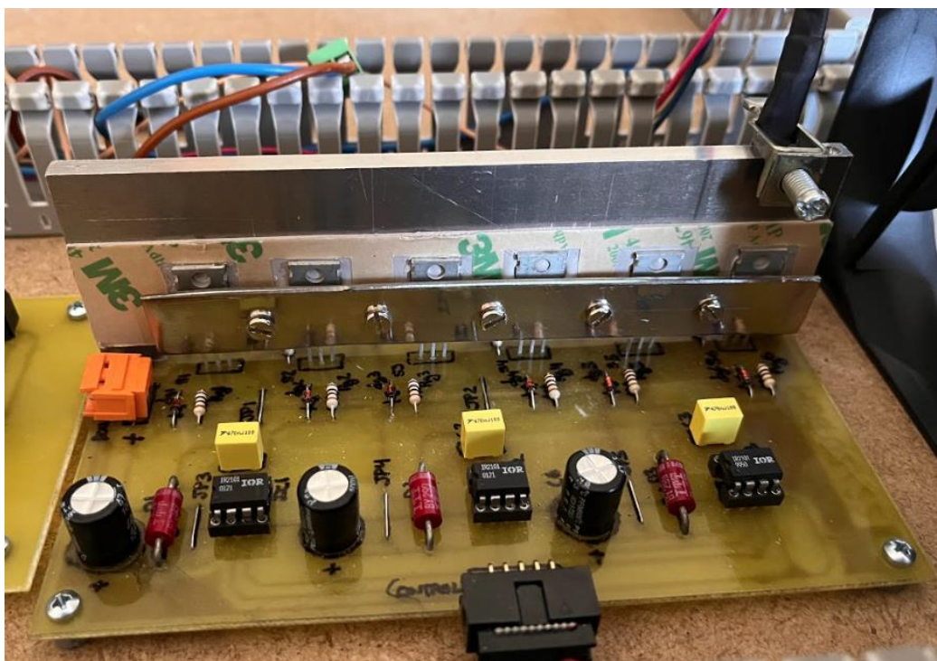
Figura 48. Disipador de calor realizado con los transistores instalados. Fuente [Propia]
