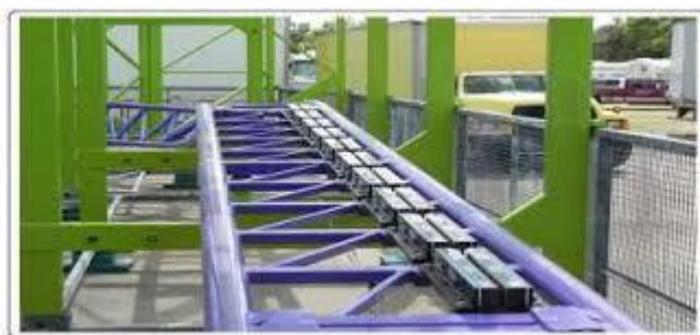
Figura 33. Freno magnético empleado en una montaña rusa. Fuentes:[20][21]
