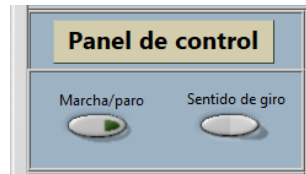
Figura 82. Controles de marcha y sentido de giro de la interfaz. Fuente [Propia]
