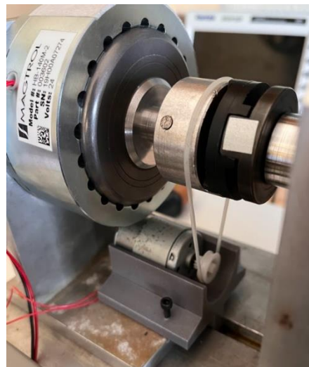
Figura 74. Montaje de la dinamo tacométrica. Fuente [Propia]
