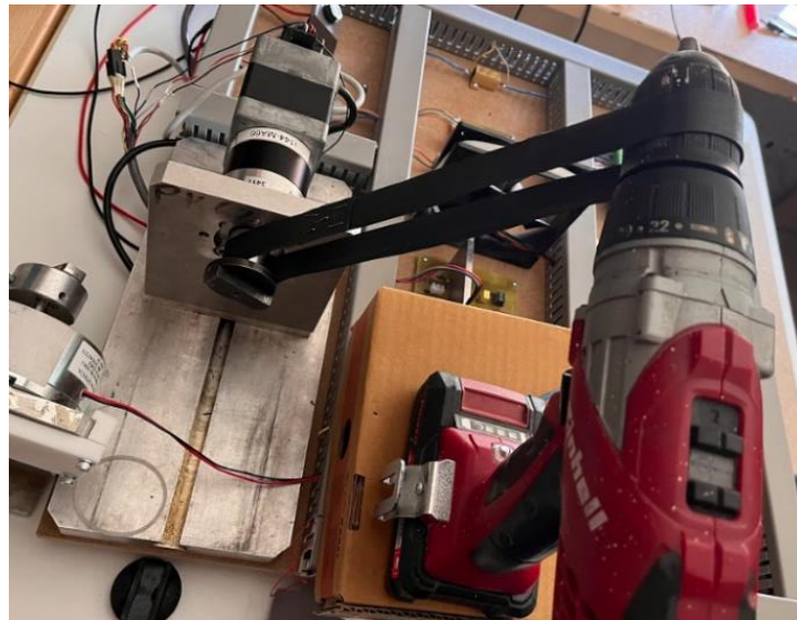
Figura 23. Giro del eje del motor BLDC mediante un taladro. Fuente [Propia]
