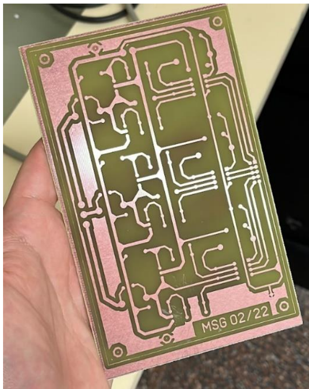
Figura 57. PCB tras el proceso de atacado con ácido. Fuente [Propia]
