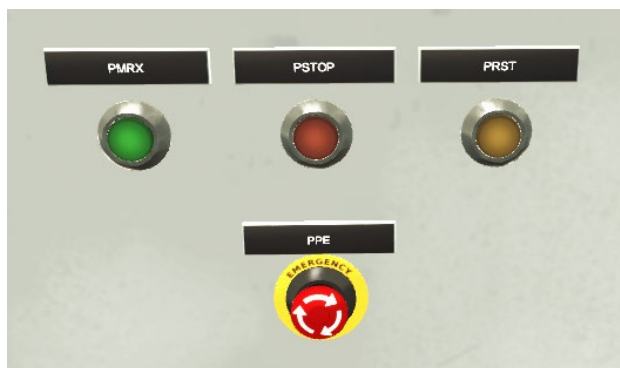
Figura 4.25. Interfície de control a camp (Font pròpia)
