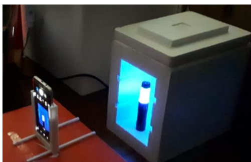
Figura 2: Disposición para la medida de fluorescencia mediante Smartphone.
