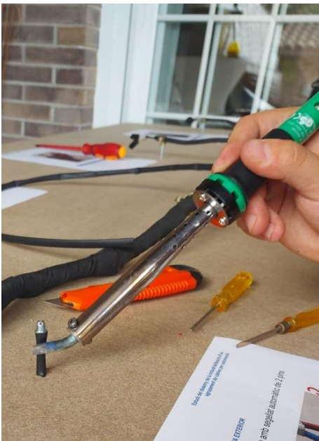
Il·lustració 66 Ús del soldador per comprimir la goma (imatge pròpia)
