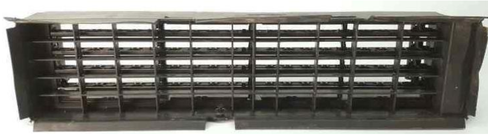
Il·lustració 20 Reixa regulable (Rejilla delantera NISSAN QASHQAI II SUV (J11, J11_) 1.5 dCi, s. f.)
