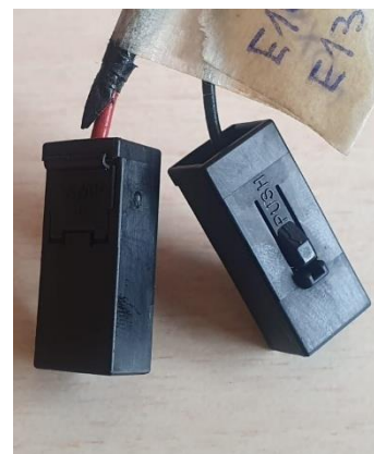
Il·lustració 35 Connectors clàxon alarma (imatge pròpia)
