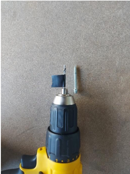
Il·lustració 59 Transferència de la marca al cargol mestre (imatge pròpia)
