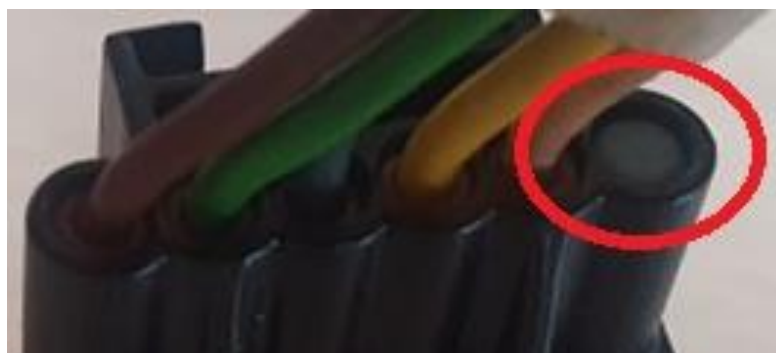
Il·lustració 31 Connector focus davanters amb aïllant de goma en el pin 6 (imatge pròpia)
