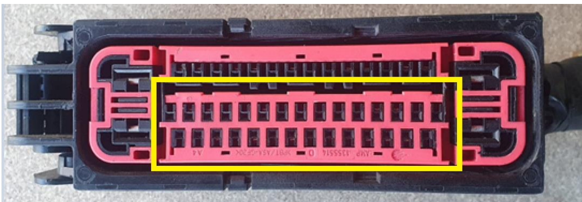
Il·lustració 41 Connector cedit per Nissan MAAS Terrassa per centraleta amb pins ressaltats (imatge pròpia)
