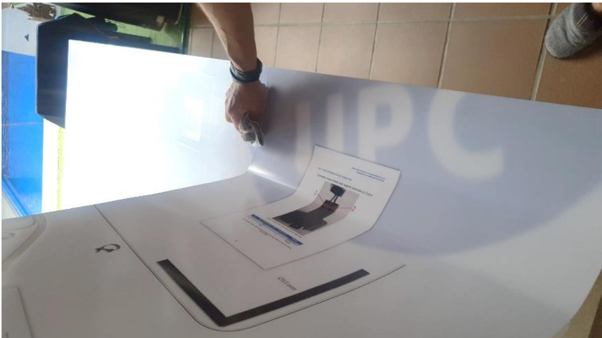
Il·lustració 85 Alineació del plotter amb la cantonada de la taula i aplicació inicial (imatge pròpia)
