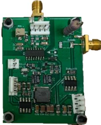
Fig. 7 Placa de convertidor DC/DC
