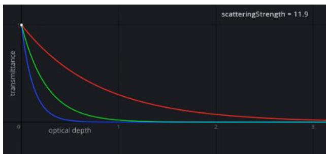
Fig. 20. Gràfic de la funció de transmitància on la força de dispersió és 11.9. Font: [26]
