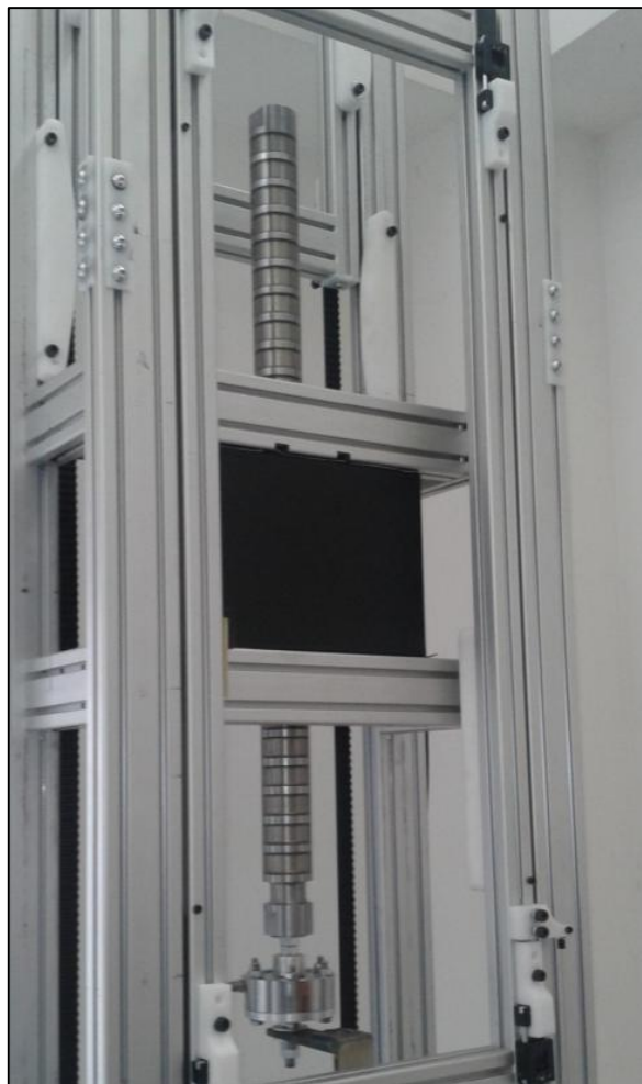
Il·lustració 38. Estructura de simulació del comportament del vaixell, test bed (Font: SeaKERS)
