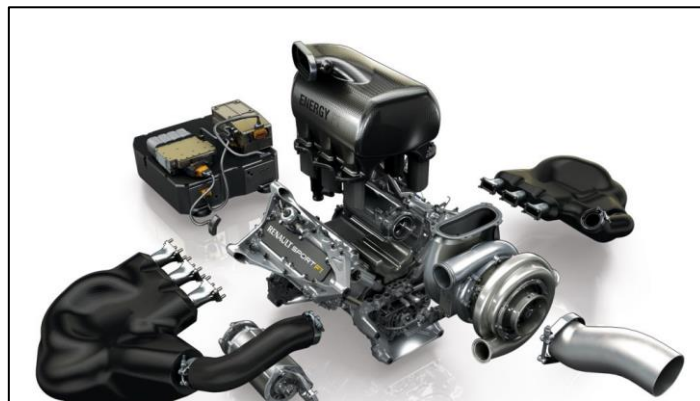
Il·lustració 14. Composició parts KERS d'un monoplaça F1 (Font: Renault)
