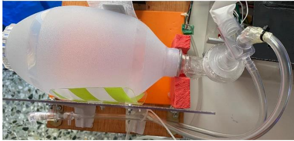
Il·lustració 19. Sistema de tubs del respirador. Font: Imatge pròpia.
