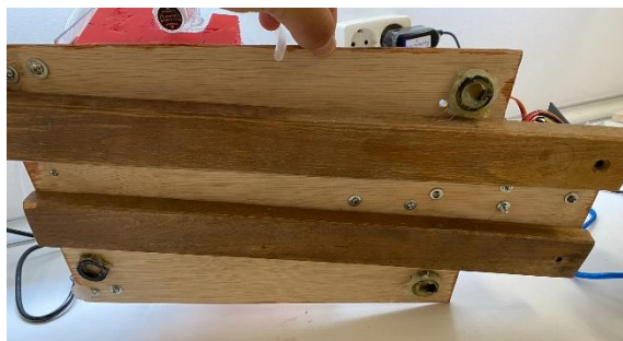
Il·lustració 50. Imatge dels dos llistons que subjecten la base del respirador per mantenir l'estructura a la mateixa altura. Font: Imatge pròpia.
