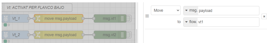
Il·lustració 43. El node anomenat "move msg.payload" ens permet guardar el valor del payload a una variable anomenada vt1, que serà fàcilment tractable posteriorment en un node de funció. Font: Imatge pròpia.
