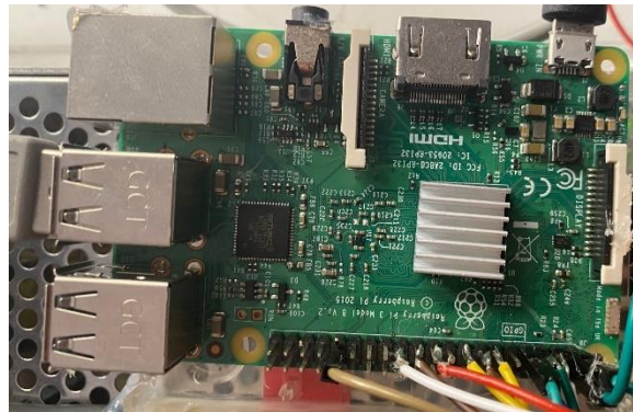
Il·lustració 23. Vista de planta de la Raspberry Pi 3 model B+ que incorpora el respirador. Es poden veure els pins a la part superior, els ports USB a la part de la dreta i la connexió HDMI a la part de sota. Font: Imatge Pròpia.
