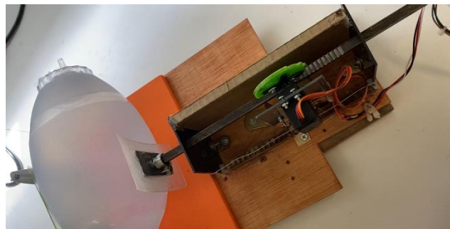
Il·lustració 52. En la imatge es pot veure la nova cremallera feta amb acer. Aportem resistència i durabilitat al respirador. Font: Imatge pròpia.
