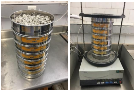
Figura 36: Realización del ensayo granulométrico en los áridos reciclados.
