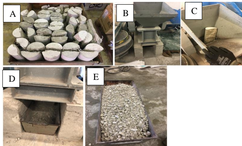
Figura 21: Proceso de reciclaje de las probetas: partición de las probetas en 2. (B) trituradora (C) trituración de las probetas. (D y E) obtención de árido reciclado.
