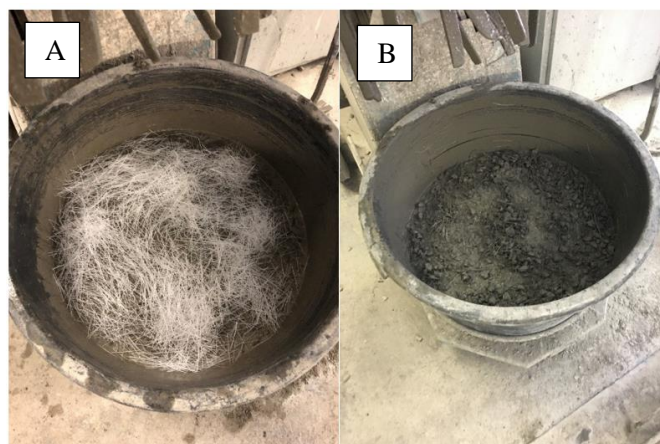
Figura 17: Adición de fibra en la mezcla; (A) fibras añadidas (B) fibras añadidas y mezcladas.
