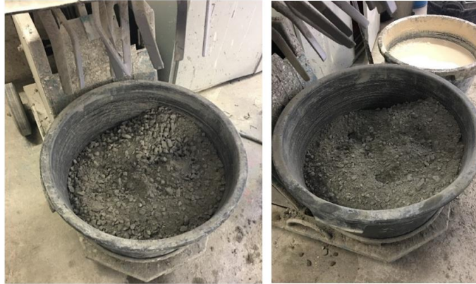
Figura 15: Mezcla de áridos secos en la mezcladora.
