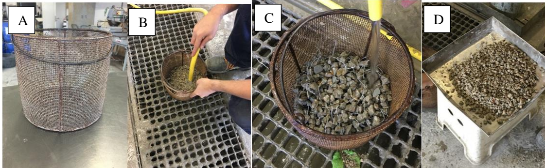
Figura 25: Obtención del contenido de finos. (A) recipiente metálico de filtración. (B, C) Lavado de árido. (D) muestra final post lavado.
