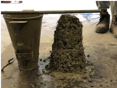
Figura 37: realización del ensayo de cono de Abraham en hormigón con fibras.
