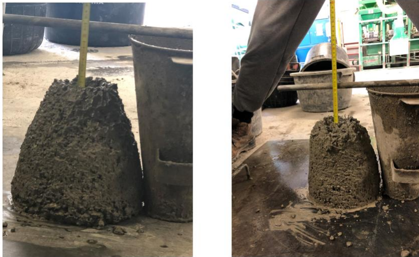
Figura 29: Realización del ensayo de cono de Abraham.
