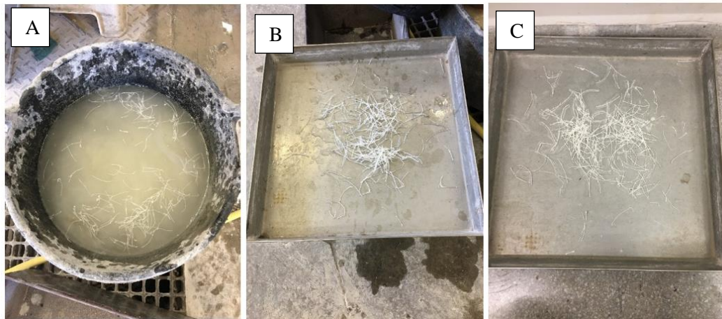
Figura 22: Obtención del contenido de fibras: (A) colección de fibras mediante flotación, (B) secado de fibras en el horno, (C) fibras secas post horneado.
