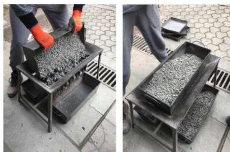
Figura 24: Cuarteo de áridos para muestras representativas.
