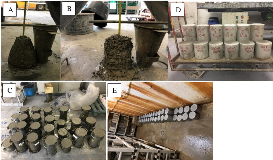
Figura 18: Diferentes procesos en la fabricación del hormigón: (A) Ensayo cono de Abraham en hormigón convencional. (B) Ensayo cono de Abraham en hormigón con fibras. (C) Relleno de probetas. (D) desmolde de probetas. (E) curado de probetas en la Cámara húmeda.
