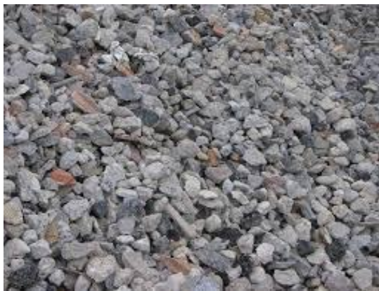
Figura 2: Áridos mixtos de hormigón (fuentes: BTB, planta de reciclaje de RCD's)
