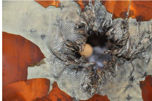
Figura 5.1: Manta de kevlar i nextel perforada. Font: Quora
