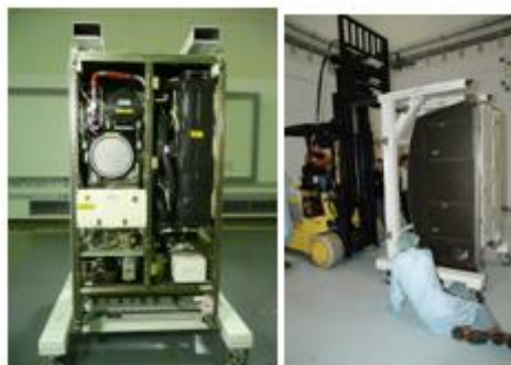
Figura 9.1: Maquinaria de generació d'oxigen. Font:Sapceflightinsider
