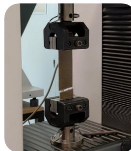
Fig 4. Trencament a tracció d'una proveta de lli
