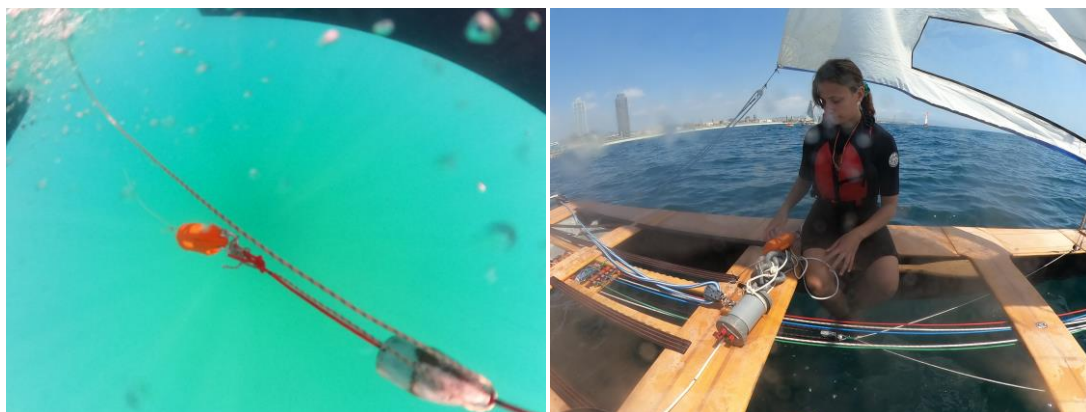
Figura 15. El CTD CastAway arrossegat pel patí (esquerra) durant una campanya i la preparació del TD i el CTD per realitzar un perfil sobre l'estació de mesura (dreta).
