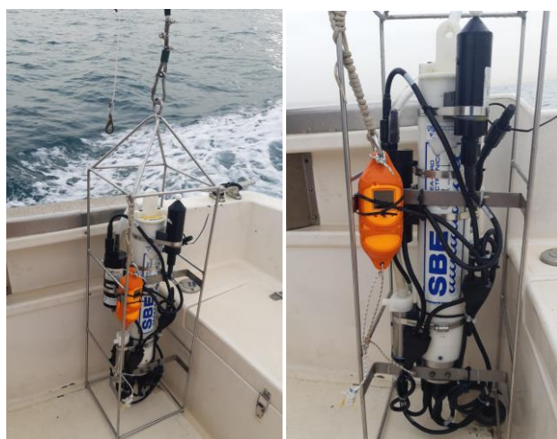
Figura 23. CTD CastAway juntament amb el CTD SBE de la PUDEM, el dia 29 de març de 2022, quan es varen realitzar perfils conjunts per a la posterior validació.
