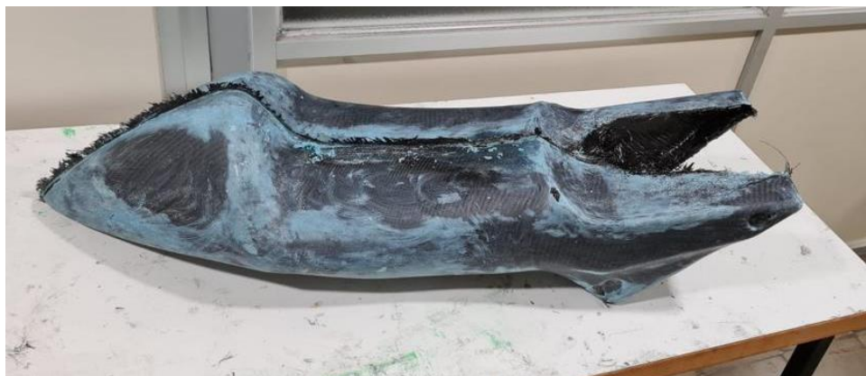
Il·lustració 56: Colin un cop retirat del motlle. Font: pròpia.
