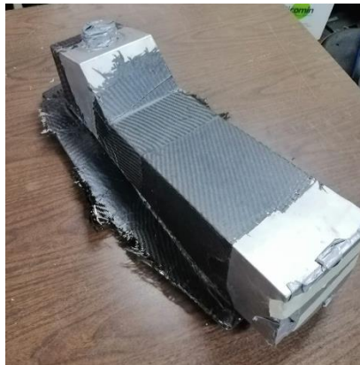
II-lustració 60: Dipòsit laminat a la tapa de fibra. Font: pròpia.
