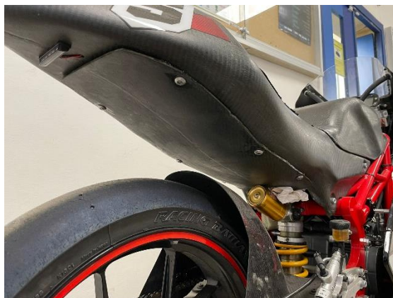
Il·lustració 61: Assemblatge colin amb dipòsit de combustible. Font: pròpia.
