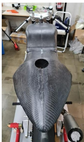
Il·lustració 62: Forat al colin per a omplir el dipòsit. Font: pròpia.
