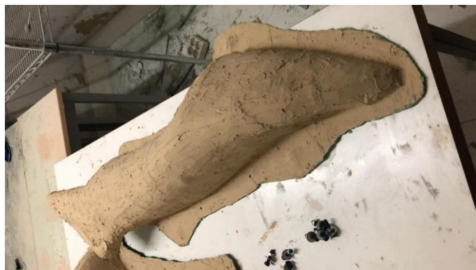
Il·lustració 57: Motlle un cop aplicat la massilla. Font: pròpia.
