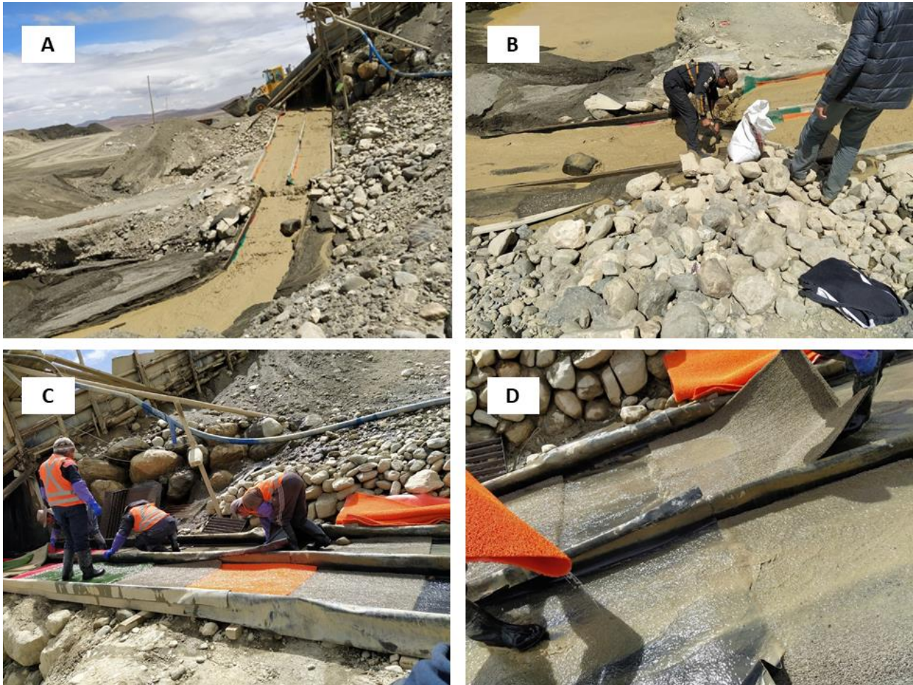
Figura 9. Canaletas. a) toma de muestra, b, c) lavado de alfombras, d) el agua de las canaletas se lleva a una poza de sedimentación para usarla nuevamente
