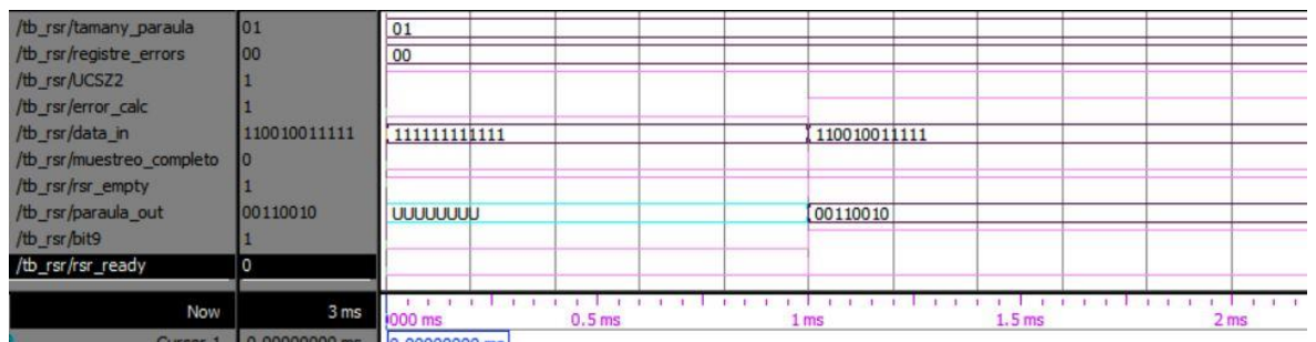
Figura 6-28: Simulació bloc RSR amb 6 bits de dades i el bit UCSZ2 activat.
