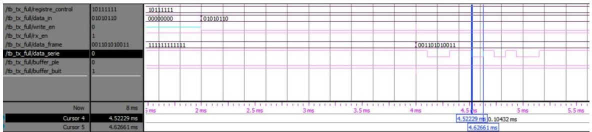
Figura 6-17: Simulacions del mòdul receptor amb 8 bits de dades, paritat activada i 2 bits de parada treballant a 9600 Bauds.
