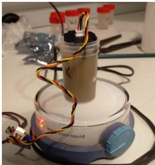
Imatge 74. Sensor de turbiditat dins una solució de calibratge. Font: Pròpia.
