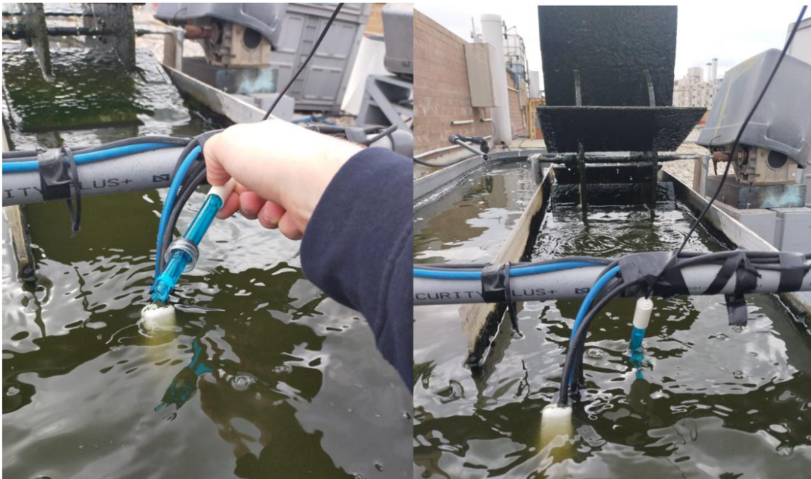
Imatge 80. Sensor de pH instal·lat a les llacunes. Font: Pròpia.
