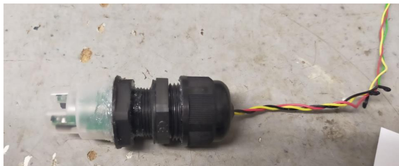
Imatge 28. Forma final del sensor de terbolesa DFRobot Turbidity sensor. Font Pròpia.
