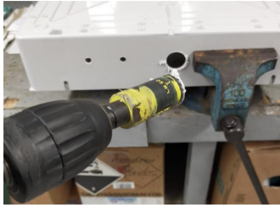
Imatge 63. Perforació de la caixa per a les obertures dels sellegats de compressió. Font: Pròpia.
