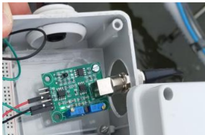
Imatge 22. Placa convertidora del sensor de pH. Font: Pròpia.
