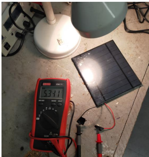
Imatge 51. Tensió de sortida de la placa solar ALLPAWERS DIY mesurada amb un multímetre. Font: Pròpia.
