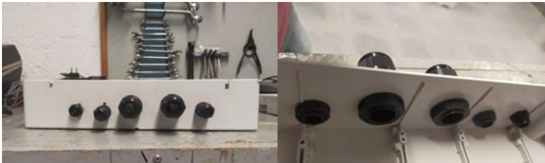
Imatge 64. Sellegats de compressió col·locats a la caixa del sensor. Font: Pròpia.
