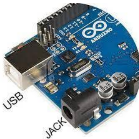
Imatge 46. Ports d'alimentació de un microcontrolador tipus Arduino. Font: practicasconarduino.com
