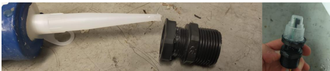
Imatge 27. Procés de ensiliconat del sellegat de compressió amb el sensor de terbolesa. Font: Pròpia.
