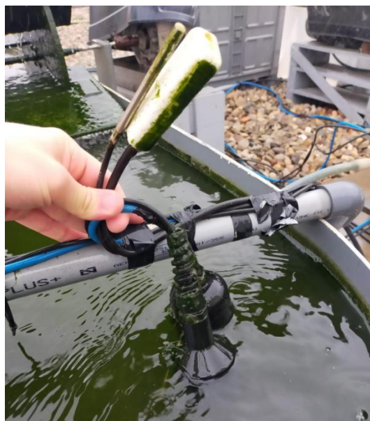
Imatge 38. Sensors de temperatura, oxigen dissolt i conductivitat instal·lats a la HRAP. Font: Pròpia.
