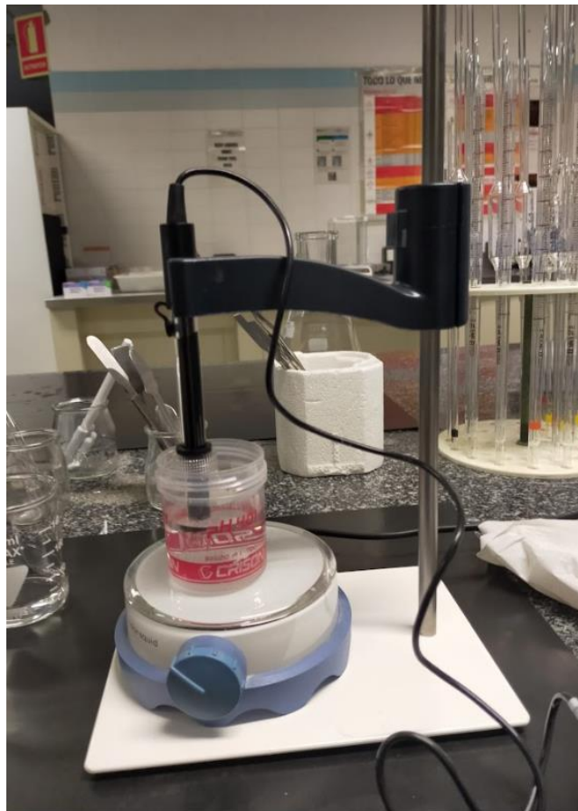
Imatge 70. Sensor de pH mesurant enregistrant el voltatge en mV del tampó. Font: Pròpia.
