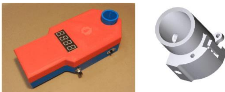
Imatge 26. Projecte de turbidímetre DIY. Font: Kelly et al (2014).
