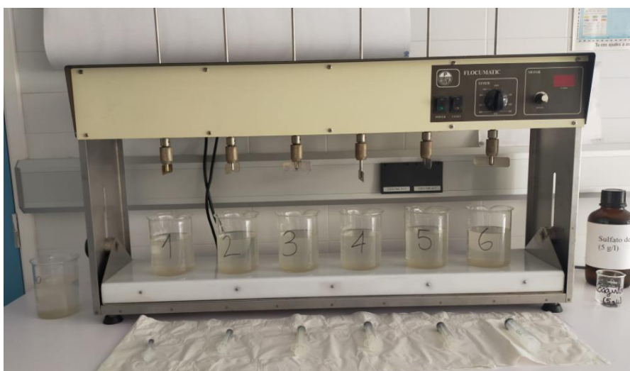
Imatge 45. Floculador de pràctiques de la UPC. Font: Pròpia.
