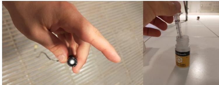
Imatge 71. Sensor de oxigen dissolt sense "bombolles" i la solució per a l'elèctrode. Font: Pròpia.
