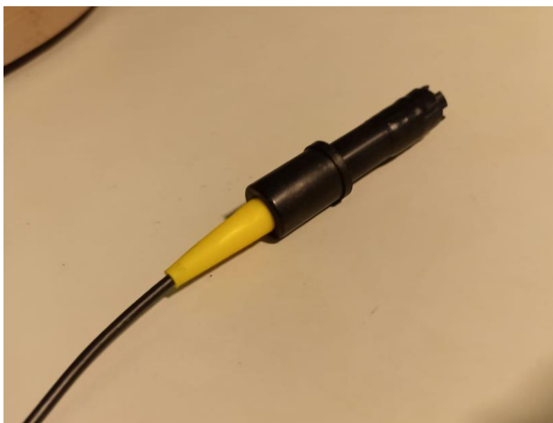
Imatge 24. Sensor de OD Atlas Scientific Mini Lab Grade. Font: Pròpia.
