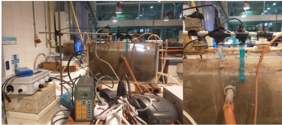
Imatge 84. Sonda de pH instal·lada per realitzar les mesures puntuals. Font: Pròpia.
