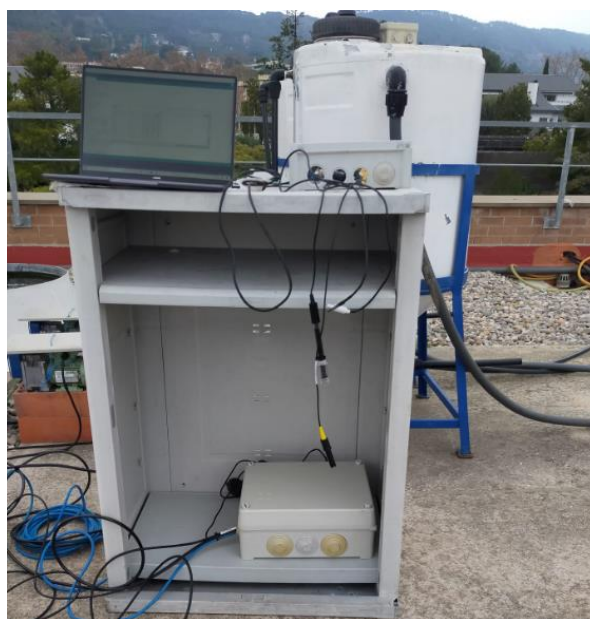
Imatge 42. Recollida de dades del sensor de temperatura i del de oxigen dissolt. Font: Pròpia.
