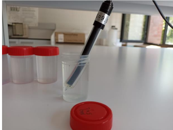
Imatge 79. Imatge de com es va col·locar el sensor amb tampones. Font: Pròpia.
