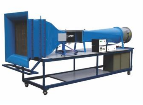
Imatge 61: Túnel de vent real de tipus Eiffel de circuit obert
