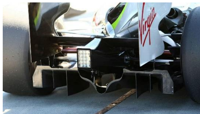
Imatge 24: Difusor d'un monoplaça de F1 situat en la part baixa de la zona posterior del vehicle entre les dues rodes
