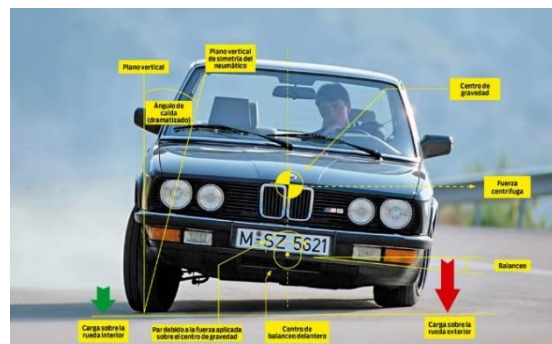
Imatge 16: Representació real d'un vehicle a velocitat alta en un revolt on es produeix moment de roll.
