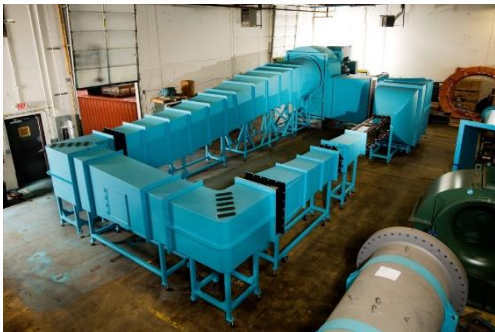
Imatge 63: Túnel de vent real de tipus tancat (retorn simple)
