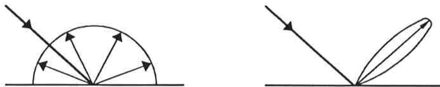
Figura 1. A la izquierda el comportamiento de una superficie perfectamente difusa, y a la derecha una superficie de tipo especular.
