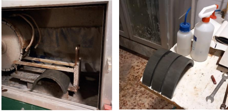
Figura 4-10 La serra amb una placa; Tres provetes acabades de tallar (d'esquerra a dreta). Font: Pròpia
