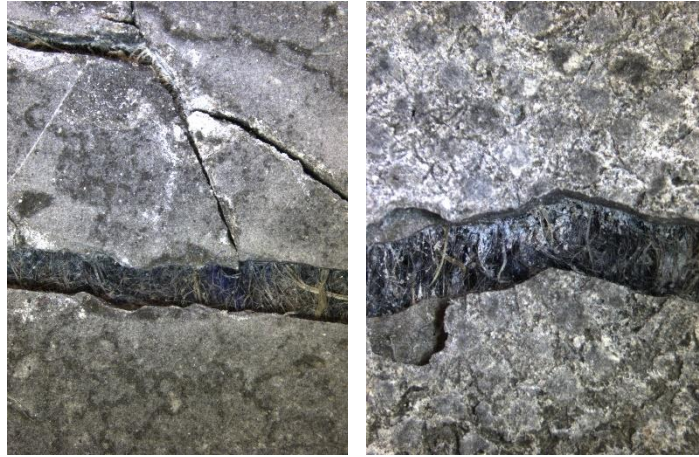
Figura 5-11 Trencaments de la part superior de les peces (20x).
