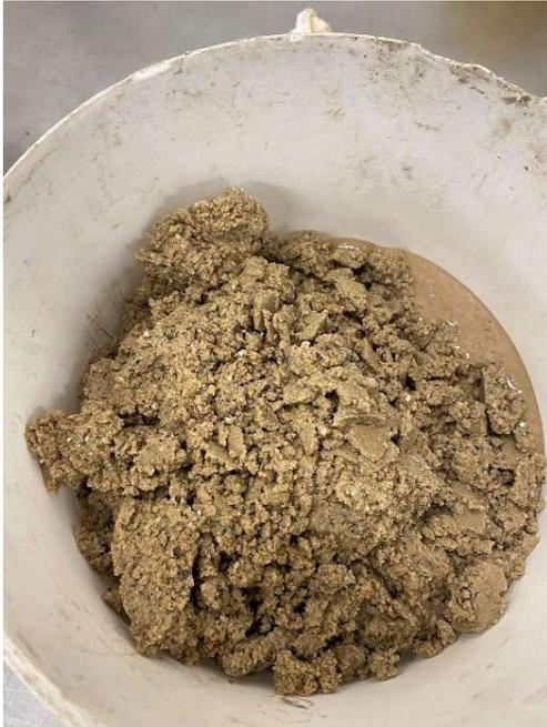
**Fig. 4. 31.** Mezcla de mortero utilizando precursor VCP (vidrio, cerámico y papel) la cual creemos que no se hizo correctamente debido a que la balanza no estaba bien calibrada.
