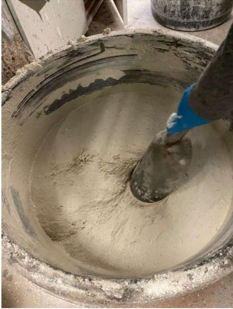
**Fig.** 4. 51. Mezcla después de agregarle 2 litros de agua más.
