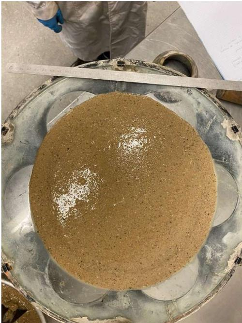
**Fig.** 4. 12. Ensayo de mesa de flujo del mortero después de los 25 golpes en 20 segundos
