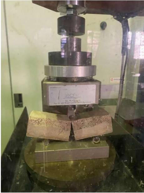
**Fig. 4. 16.** Momento en que la viga falló, soportó 1,57 kN
