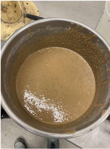
**Fig. 4. 27.** Mezcla de mortero utilizando precursor VCP (vidrio, cerámica y papel) con dosificación de arriba.
