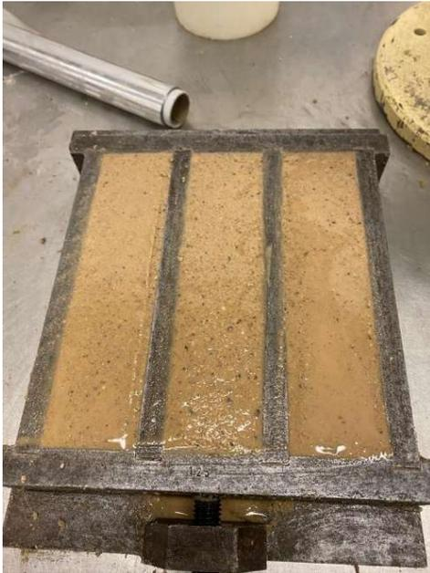
**Fig. 4. 39.** Mortero de la segunda mezcla colocado en el molde de las vigas.
