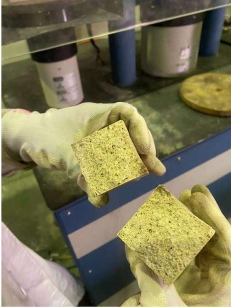
**Fig. 4. 18.** Viga 2 fracturada, soportó 1,79 kN a flexión
