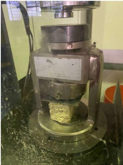
**Fig. 4. 19.** Sometiendo la misma viga 2 a prueba de compresión.
