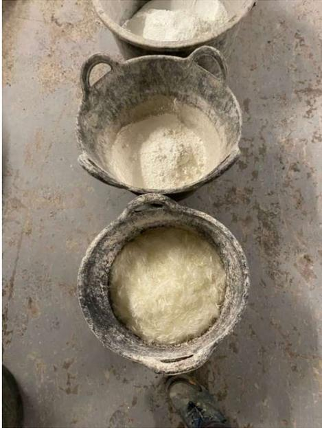
**Fig. 4.45.** Fibra y cemento utilizado para la mezcla.
