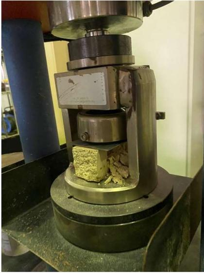
**Fig.** 4. 20. Momento en el que la viga 2 falló, soportó 47,13 kN.
