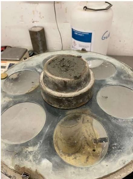
**Fig.** 4. 21. Ensayo de mesa de flujo para el mortero.
