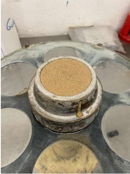
**Fig. 4. 28.** Preparación de ensayo de mesa de flujo para la mezcla.
