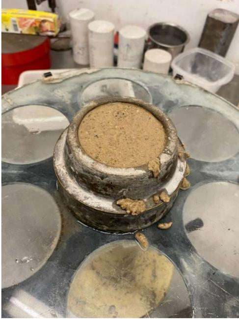
**Fig.** 4. 11. Ensayo de mesa de flujo para el mortero.
