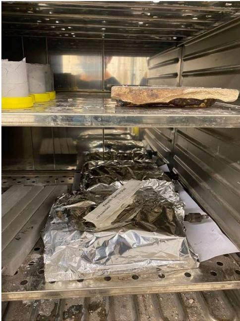
**Fig.** 4. 14. Las 5 vigas introducidas en el horno a 70 °C selladas con papel plástico y papel aluminio.
