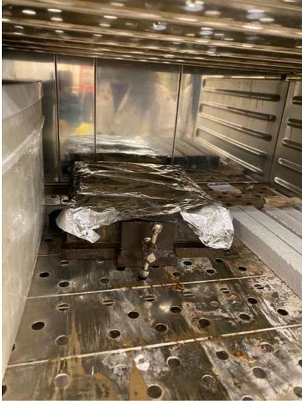
**Fig. 4. 38.** Primeras 3 vigas colocadas en el horno a 70 °C.
