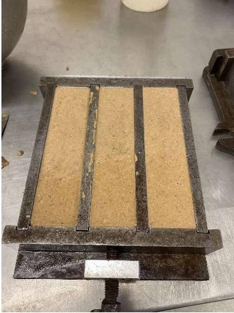
**Fig. 4. 30.** Mortero ya colocado en el molde para vigas.
