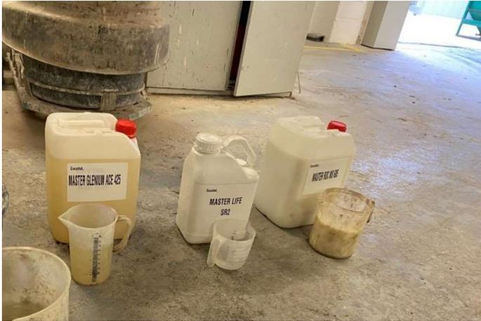
**Fig. 4. 47.** Aditivos utilizados para la mezcla.
