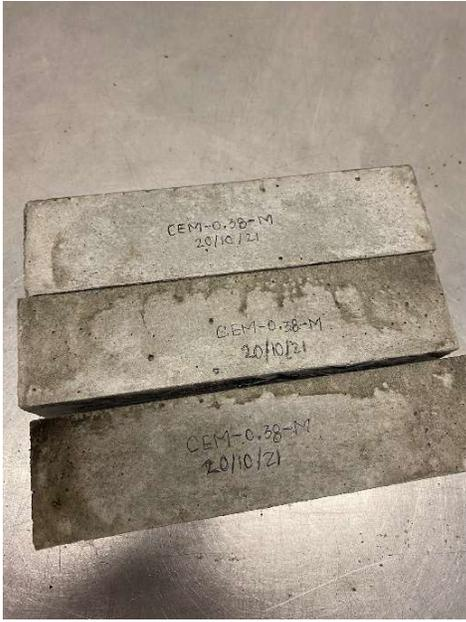
**Fig. 4. 32.** Desencofrado de vigas hechas el 20/10/2021.
