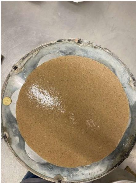
**Fig. 4. 29.** Ensayo de mesa de flujo de la mezcla de mortero después de los 25 golpes en 20 segundos.
