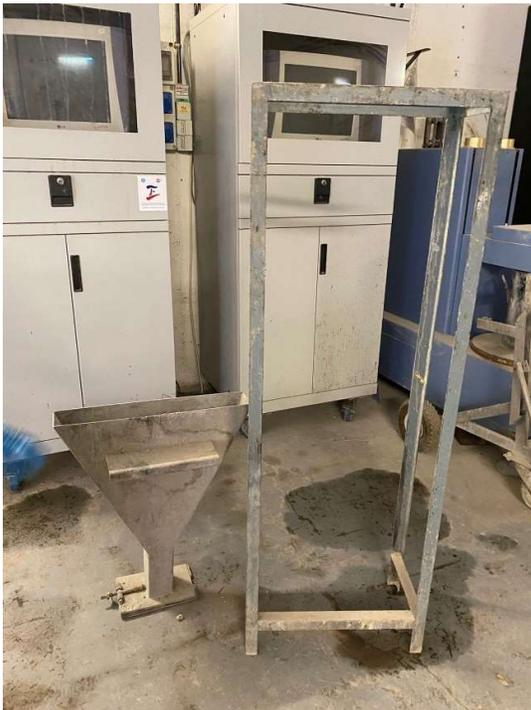
**Fig. 4. 48.** Equipo utilizado para el ensayo Embudo en V.
