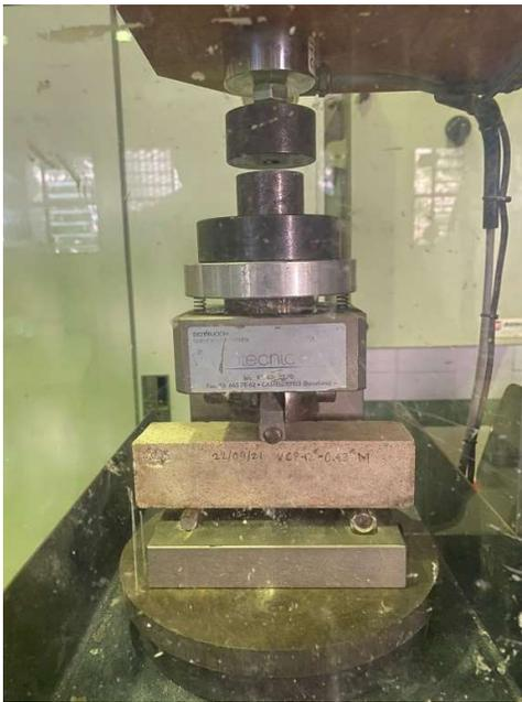
**Fig. 4. 17.** Sometiendo viga 2 fraguada hace 28 días a prueba de flexión
