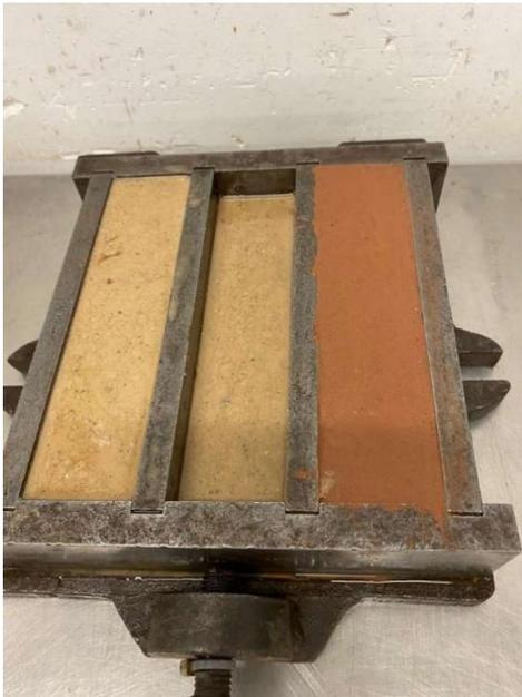
**Fig. 4.43.** Lo que sobró de las mezclas tanto de la que se hizo con VCP (vidrio, cerámica y papel) y la que se hizo con testillo se acomodó en otro molde de vigas las cuales se dejaron afuera.
