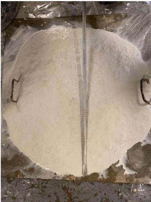
**Fig.** 4. 52. Ensayo Slump Flow, el flujo se deformó.
