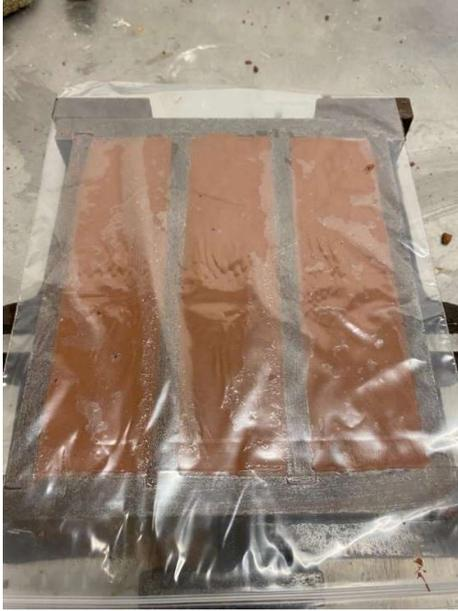
**Fig. 4.42.** Mortero hecho utilizando como precursor testillo ya en el molde de las vigas, sellado con plástico para meterlo al horno a 70 °C.
