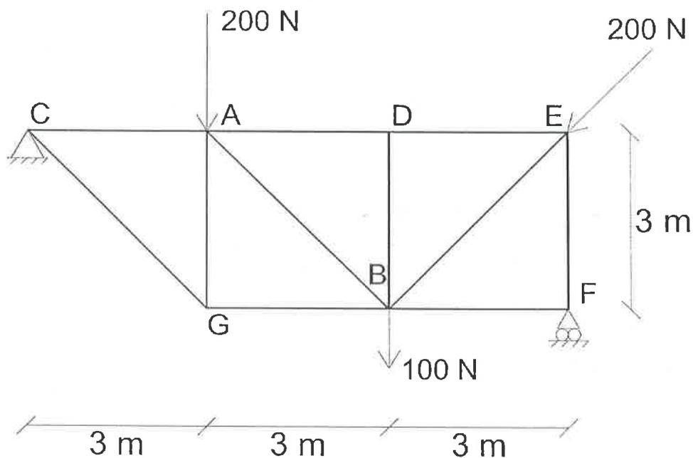
2.23.- Determinad por el método de los nudos los esfuerzos de cada barra en la armadura plana de la figura, especificando su valor y su forma (tracción o compresión).
