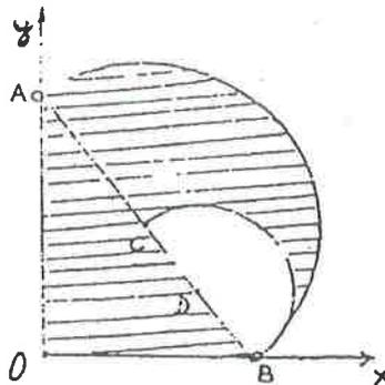
3.5.- Determinar, por el teorema de Pappus-Guldin, el volumen engendrado por la figura sombreada al girar  $270^\circ$  alrededor del eje "X" (distancias en cm).
