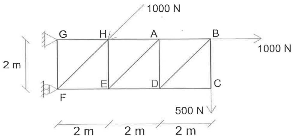
2.25.- Para la siguiente armadura calcular las fuerzas en las barras BC y CD por el método de las secciones.
