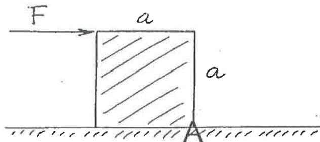
2.19.- Encuentra el ángulo máximo  $\alpha_{\max}$  a partir del cual el cuerpo volcará (suponed que el coeficiente de rozamiento es lo suficientemente grande).
