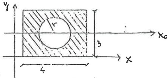
3.8.- En la placa plana, homogénea y uniforme que se muestra en la figura las dimensiones están en metros.
