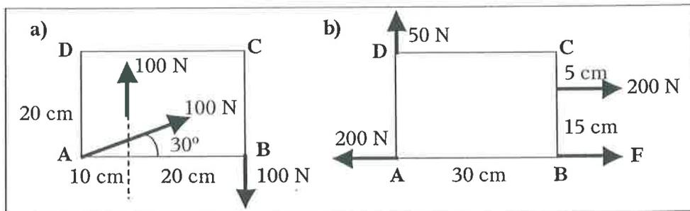
1.26.- Determinad el valor de las fuerzas  $F_A$ ,  $F_B$  y el momento  $M$ , que hay que aplicar en  $B$ , para que los sistemas representados en las figuras a) y b) sean equivalentes.
