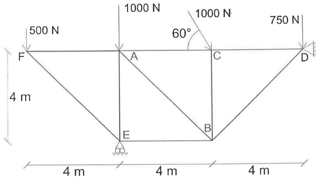
2.24.- Determinad por el método de los nudos los esfuerzos de cada barra en la armadura plana de la figura, especificando su valor y su forma (tracción o compresión).
