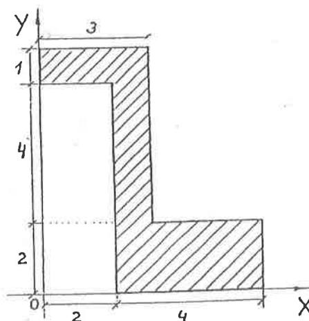
3.9.- La pieza representada en la figura tiene espesor uniforme y sus dimensiones están expresadas en metros.
