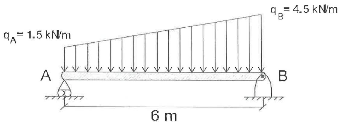
2.32.- Representad los diagramas de fuerzas cortantes y momentos flectores para la viga y la carga indicada.
