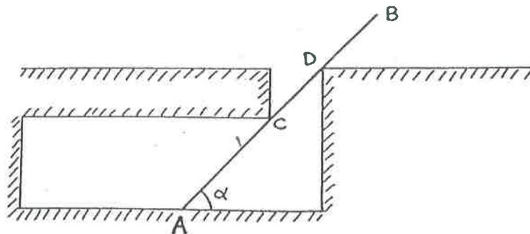
2.5.- Una escalera de 20 kg mide 3.6 m. La escalera está apoyada contra una pared vertical lisa y su extremo inferior descansa sobre un suelo rugoso a 1.2 m de distancia de la pared (ver figura). Determinar las reacciones en ambos extremos y observar si tienen la misma inclinación que la escalera.
