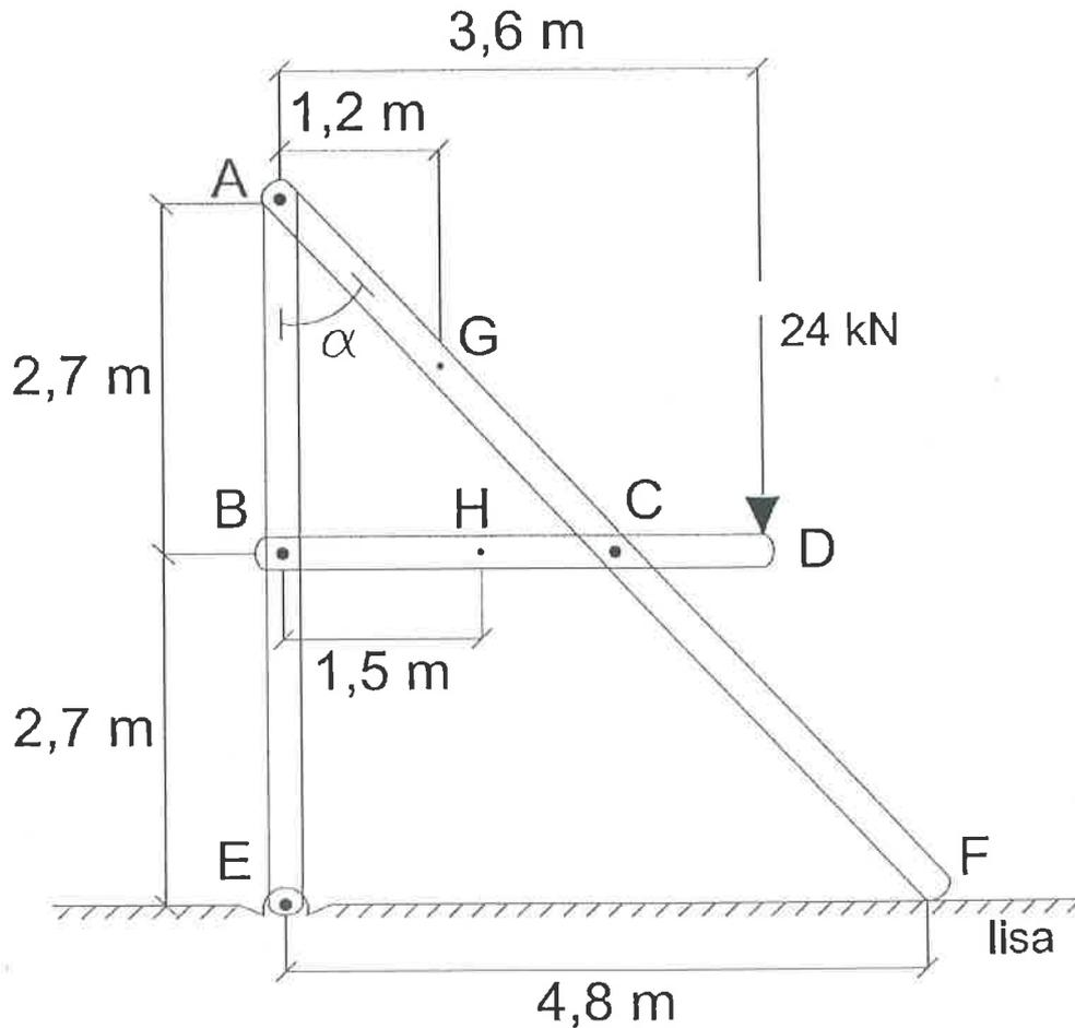
2.28.- Utilizando los datos y los resultados del problema anterior, calcular la fuerza axial N, la fuerza cortante T y el momento flector M en los puntos G (barra ACF) y H (barra BCD).
