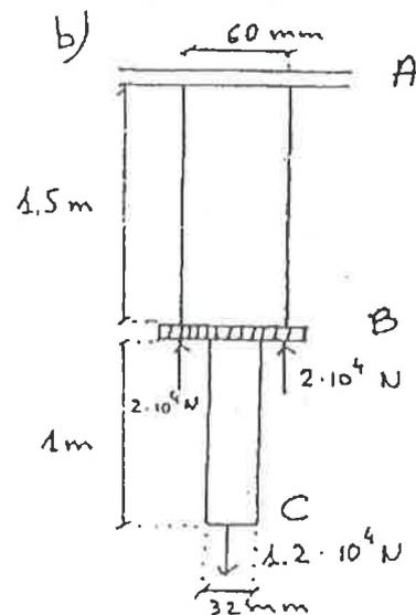
5.7.- Dos varillas sólidas de sección circular están soldadas en B como se muestra en la figura b). Si la varilla AB es de aluminio, con módulo de Young  $Y_a = 7 \cdot 10^{10}$  Pa, y la varilla BC es de cobre, con  $Y_c = 12 \cdot 10^{10}$  Pa, determinar la variación de longitud de ambas varillas y el desplazamiento del punto C.
