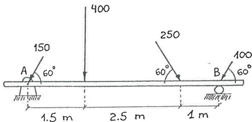
2.2.- La barra de la figura tiene una articulación en A y un apoyo liso en B. Las fuerzas aplicadas se expresan en kp y prescindimos del peso de la barra. Calcular:
