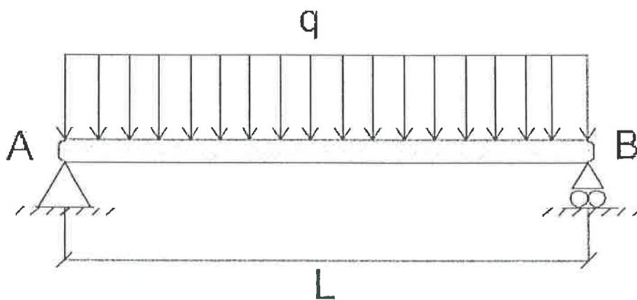
2.37.- Representad los diagramas de fuerzas cortantes y momentos flectores para la viga y la carga indicada en el problema anterior con  $L = 6\text{ m}$  y  $q = 4\text{ kN/m}$ .
