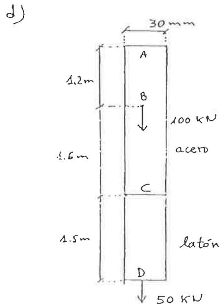
5.9.- La varilla de acero ABC, de 30 mm de diámetro, y la varilla de latón CD, del mismo diámetro, están unidas en el punto C para formar la varilla de longitud ABCD (figura d). Para la carga mostrada, y despreciando el peso propio de la varilla, hallar la variación de longitud del conjunto.
