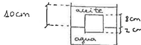
4.6.- Un bloque cúbico de madera de 10 cm de arista y de densidad  $0.5 \text{ g/cm}^3$  flota en un recipiente con agua. Se vierte en el recipiente aceite de densidad  $0.8 \text{ g/cm}^3$  hasta que la superficie superior de la capa de aceite se encuentra 4 cm por debajo de la cara superior del bloque.
