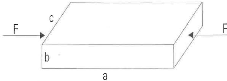
5.11.- En cada extremo de una barra horizontal de 1.5 m de largo, 1.6 cm de ancho y 1 cm de alto se aplica una fuerza de tracción de 2800 N. El módulo de Young y el coeficiente de Poisson del material de la barra son  $Y = 2 \cdot 10^{10}$  Pa y  $\mu = 0.3$ . Calcular:
