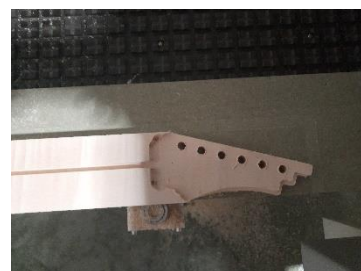
Imatge 6.3.3-2: Mecanitzat mànec
