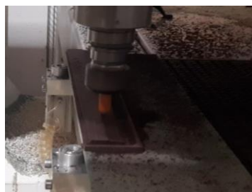
Imatge 6.3.3-6: Mecanitzat diapasó
