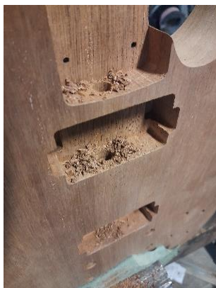
Imatge 6.4.1-1: Forats per cablejat
