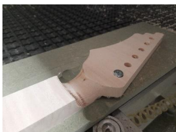
Imatge 6.3.3-5: Mecanitzat mànec
