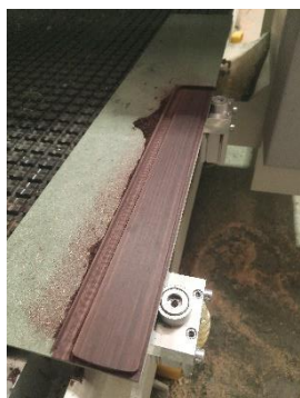
Imatge 6.3.3-5: Mecanitzat diapasó
