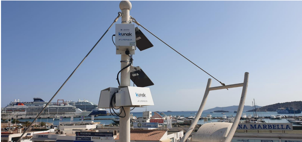
Figura 6 Sensores de medición de partículas y ruidos. Fuente: Autoridad Portuaria Baleares
