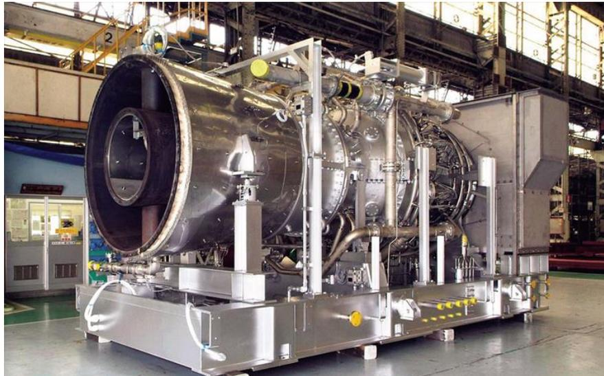
**Figura 23. Proyecto de turbina de gas alimentada con  $\text{NH}_3$ . Fuente: Mitsubishi Power**
