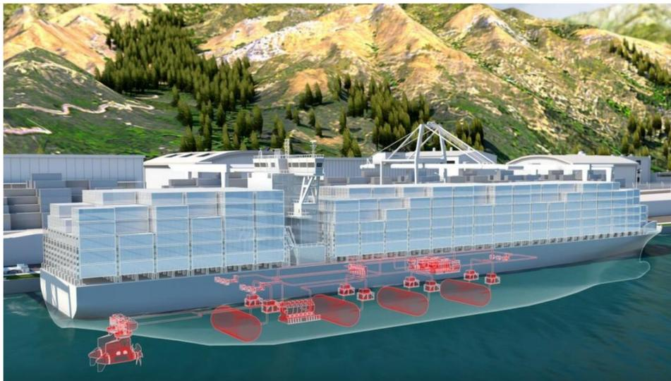
**Figura 30. Esquema buque portacontenedores alimentado con pilas de H<sub>2</sub>. Fuente: Riviera Maritime Media**
