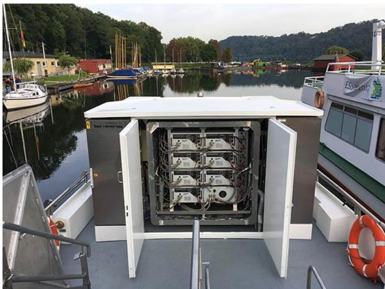
**Figura 37.** Pilas de metanol del buque *MS Innogy*. Fuente: [sectormaritimo.es](http://sectormaritimo.es)
